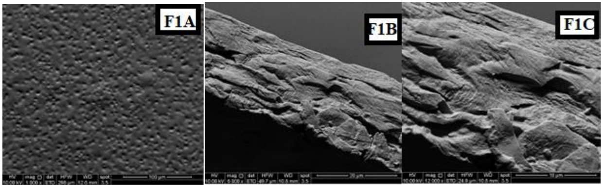
Figura A1. HPMC antes de la impresión F1 (F1A) corresponde a la superficie antes de la impresión con aumento de 1000x, (F1B) Y (F1C) corresponde al corte transversal de F1 con aumento de 6000x Y 12000x respectivamente.
