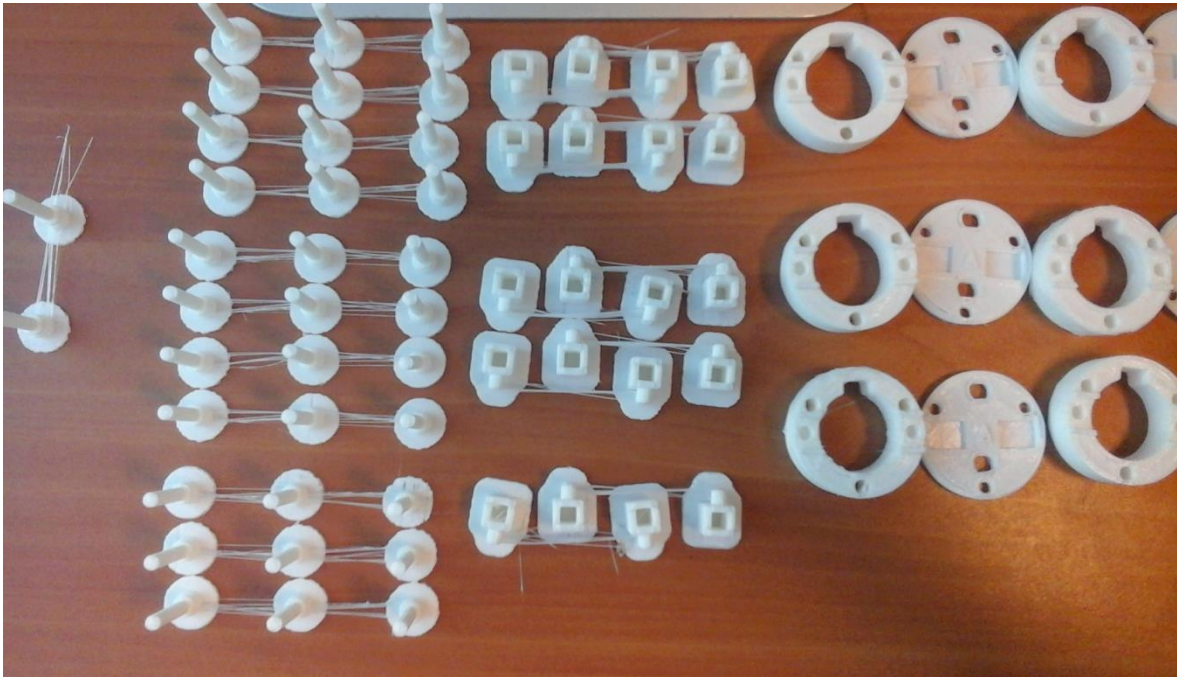
Figura 4.11 Piezas en bruto, se observan las piezas impresas en PLA.
