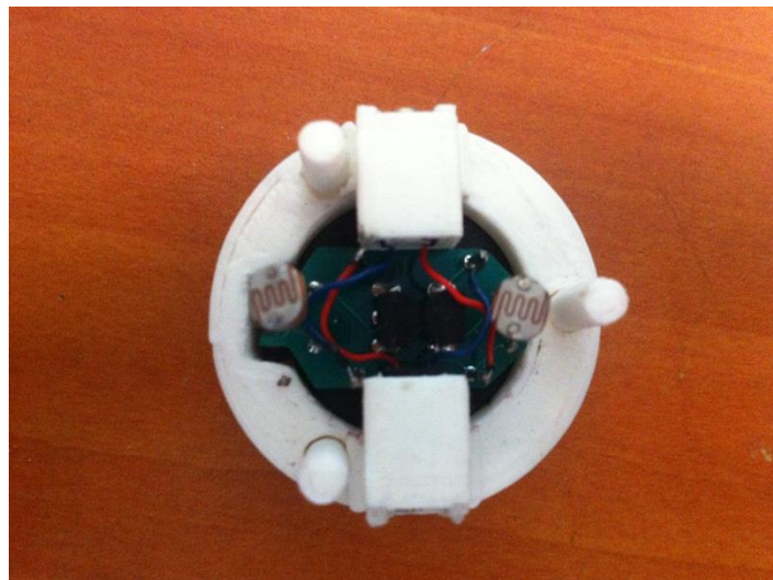
Figura 4.16 Robot con PCB más componentes soldados
