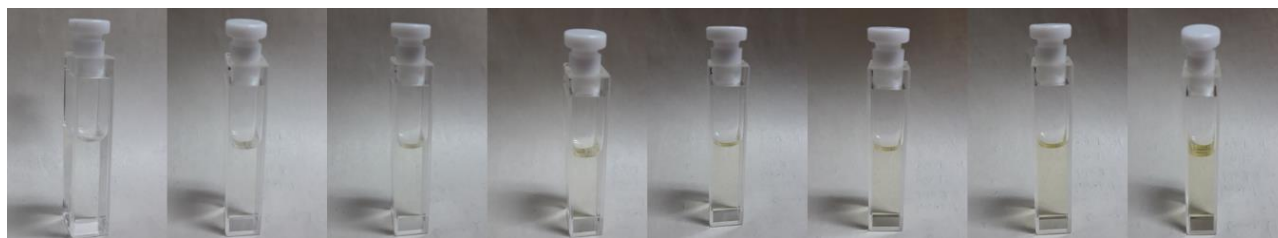
Figura 45.- Colorimetría del receptor VIII (7,88 \mu\text{M} ) en acetonitrilo con 0, 2, 4, 6, 8, 10, 15 y 20 equivalentes de catión Cu (II).
