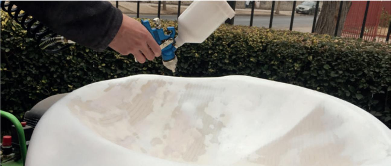
Figura 59: Fotografía aplicando masilla de pistola a la pieza maestra o máster.
