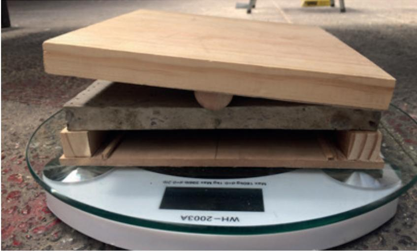
Figura 11: Máquina para examen mecánico de flexión para baldosas.
