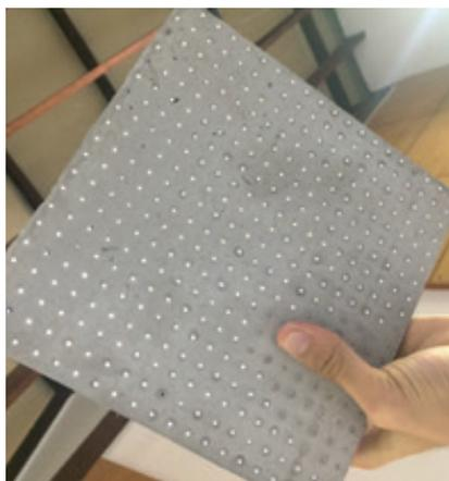
Figura 7: Palmeta de cemento translúcido con filamentos de nylon.
