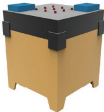
Figura 8: Modelo 3D de la máquina medidora de luz residual.
