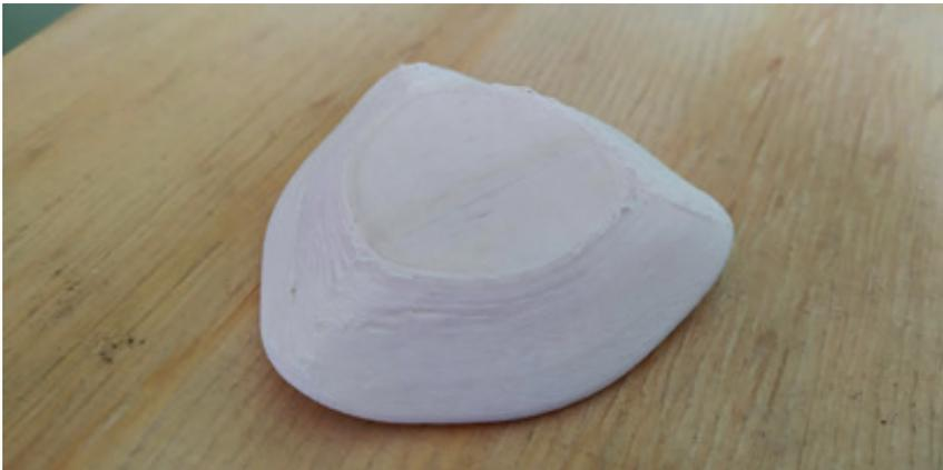
Figura 40: Segundo modelo en 3D impreso en FDM.
