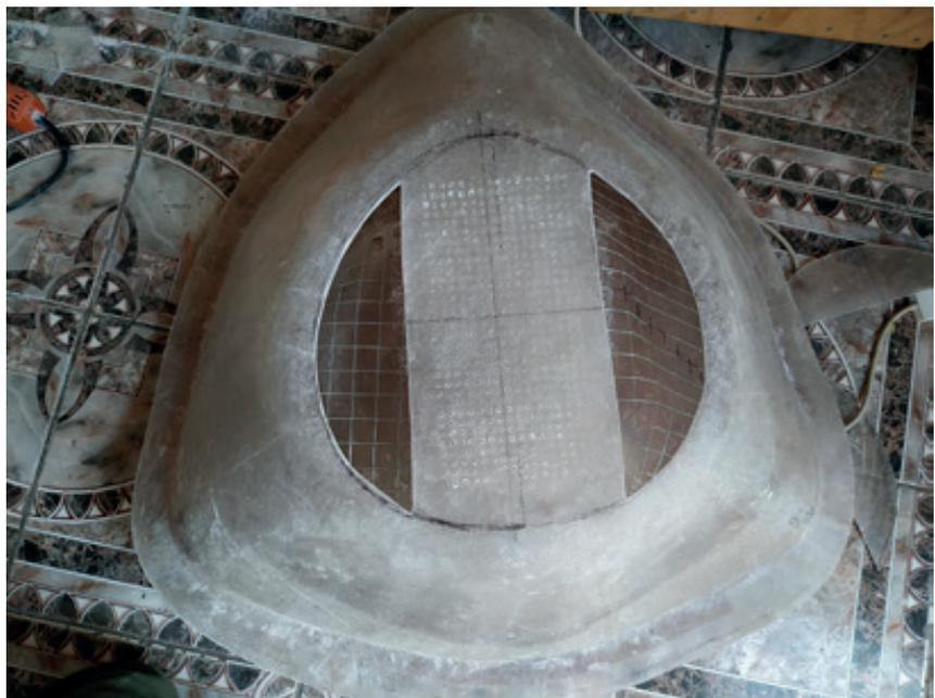
Figura 68: Fotografías de la malla de alambres interna.
