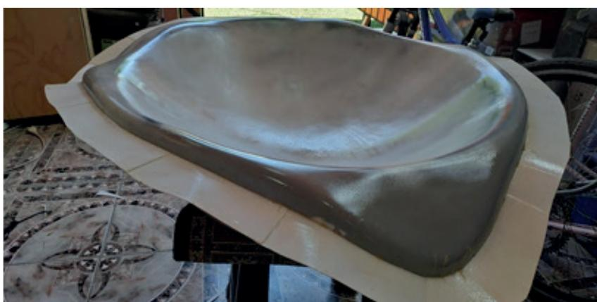
Figura 63: Fotografías de la preparación del master para el molde.
