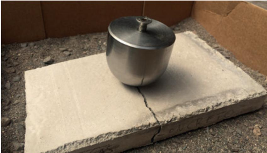
Figura 13: Máquina para examen mecánico de impacto para baldosas.
