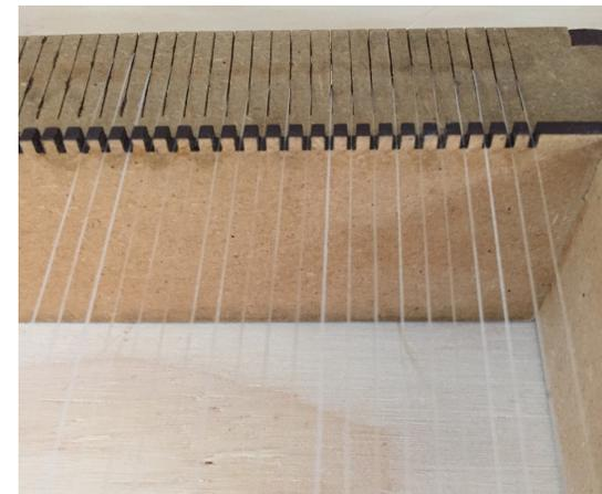
Figura 79: Fibras tensadas y separadas con el modo 2.
