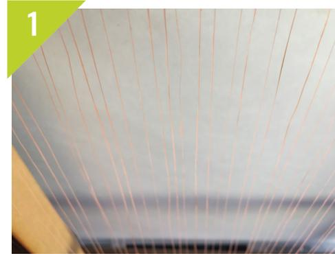
Retirar la superficie cubierta de polietileno y dejar secar las fibras manteniéndolas en contacto solamente con el instrumento ya sea de manera horizontal (dado vuelta) o vertical por 30 min.
