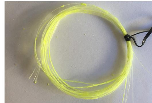
Figura 81: Resultado del desprendimiento de la pintura transparente con el modo 2.
