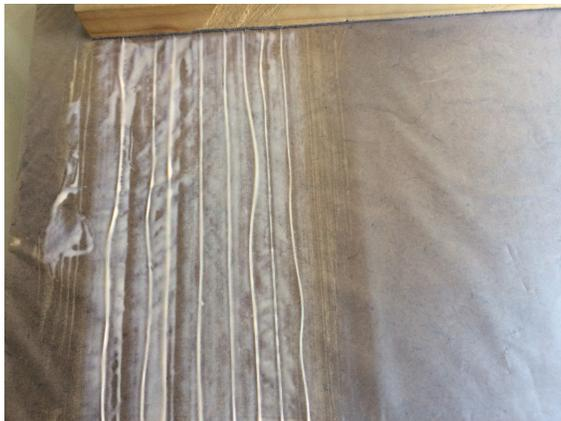
Figura 78: Fibras difícilmente separadas y estiradas con el modo 1.
