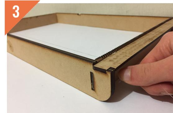
3 Se introduce el extremo restante de la fibra en el corte de la pieza, asegurando que la fibra quede tensa. De ser necesario, se puede anudar los extremos de la fibra para obtener una mayor firmeza.
