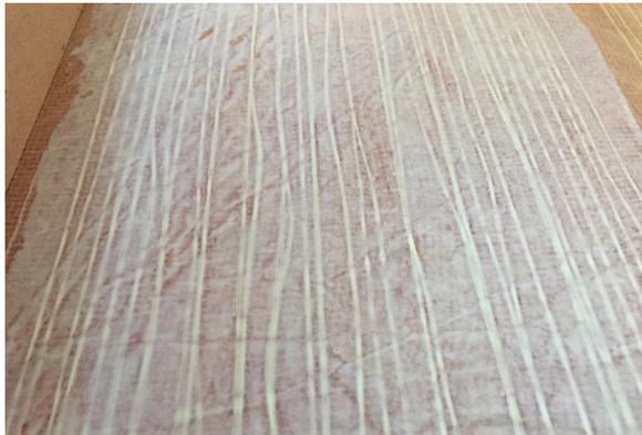
*Figura 77: Fibras de crin cubiertas por la solución.*
