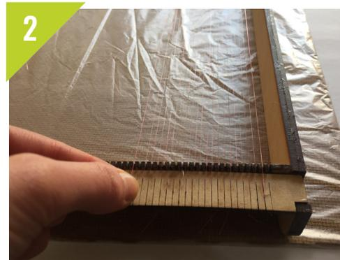
Se retiran los extremos de las fibras en ambos lados de los cortes.
