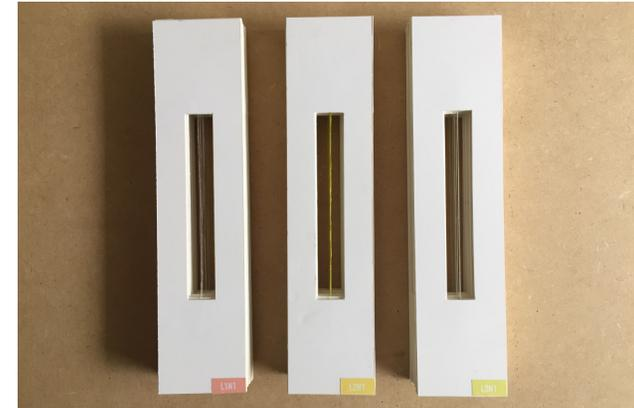
Figura 100: Sets de probetas para ensayo de tracción.
