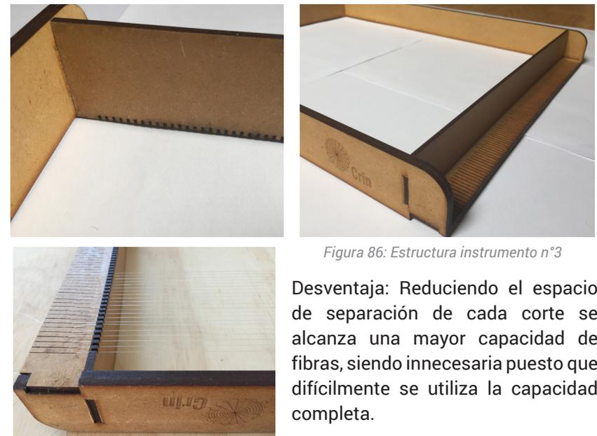
Figura 86: Estructura instrumento n°3
