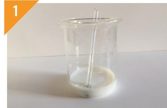
Considerada la cantidad que se desea teñir, verter la resina acrílica en un vaso precipitado hasta que mida la cantidad requerida.
