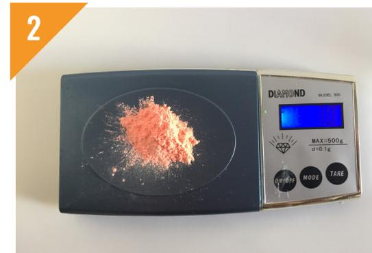
Se pesa el pigmento en una balanza digital de precisión.
