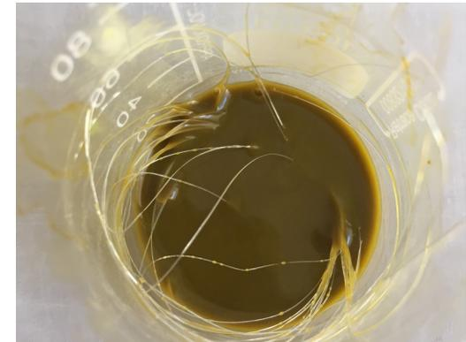
Figura 64: Fibra de crin sumergida en la solución.
