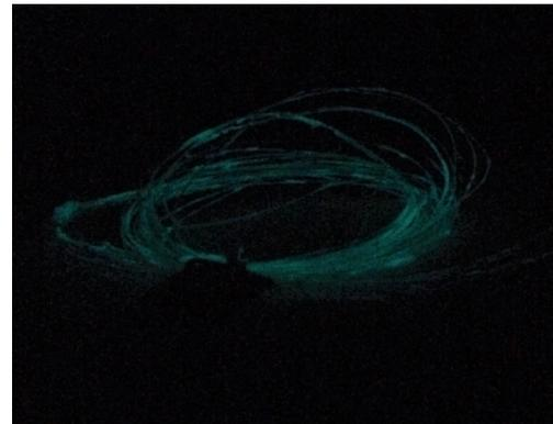
Figura 70: Fosforescencia del crin con resina acrílica.
