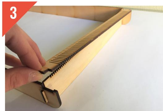
2 de las 3 piezas anexas con cortes longitudinales (C) se sitúan en cada extremo y se unen a través de los encajes de la pieza A.
