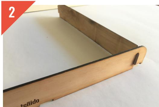
Cada pieza de mayor longitud (A) se une a la pieza dentada (B) perpendicularmente a través de las aberturas de la pieza A. Los bordes dentados de la pieza B deben quedar posicionados hacia abajo en dirección a la superficie.
