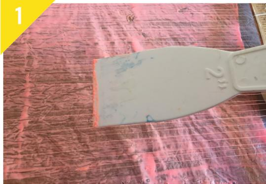
Se vierte la solución sobre las fibras sujetas en el instrumento y se esparce la solución a lo largo de las fibras través de una espátula lisa de plástico.
