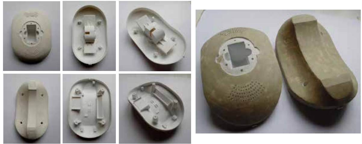
Figura 119. Prototipo funcional impreso en 3D previo a la aplicación de pintura. Autoría propia.
