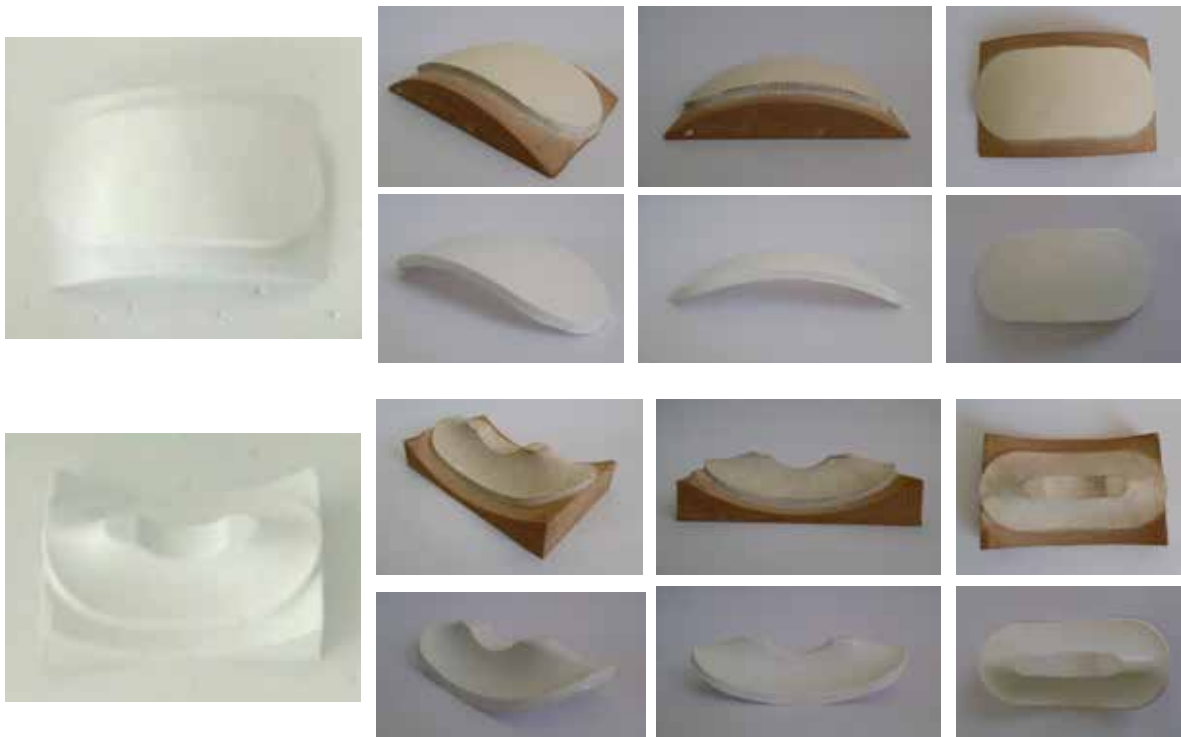
Figura 99. Izquierda: Piezas termoformadas listas. Derecha: Piezas cortadas y separadas del máster junto a su comparación con los respectivos moldes. Autoría propia.
