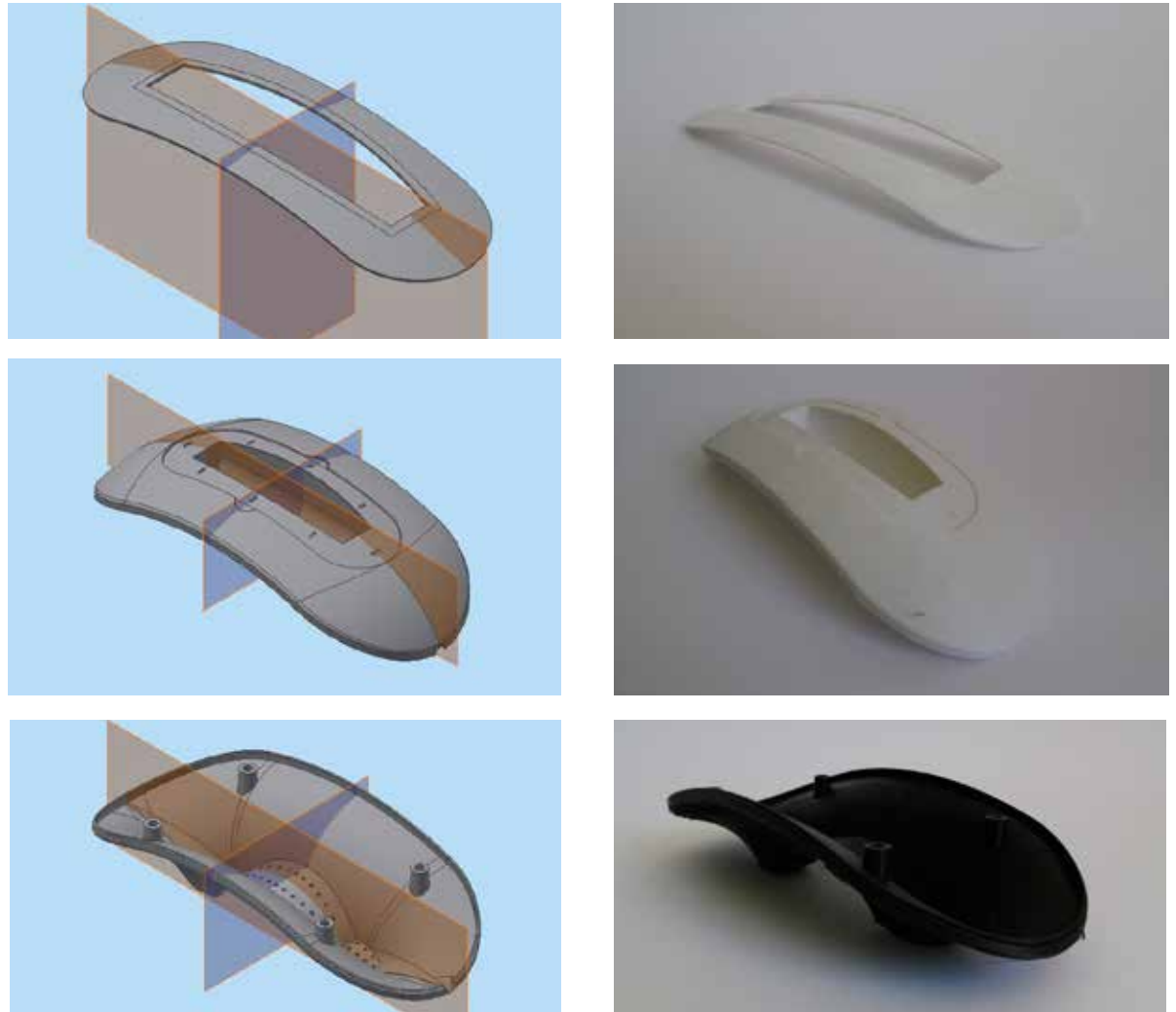
Figura 100. Secuencia de piezas modeladas en 3D en Autodesk Inventor y su comparación con el resultado en el proceso de impresión 3D. Elaboración y autoría propia.
