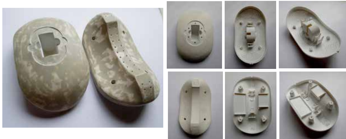
Figura 121. Prototipo estético/ergonómico impreso en 3D previo a la aplicación de pintura. Autoría propia.
