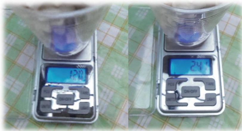
Figura n°39: "Pesaje de componente A y componente B" (Elaboración Propia).
