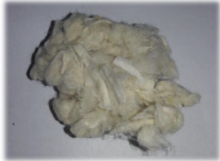
Figura nº36: "Resultado final proceso de escarmenado manual" (Elaboración Propia).
