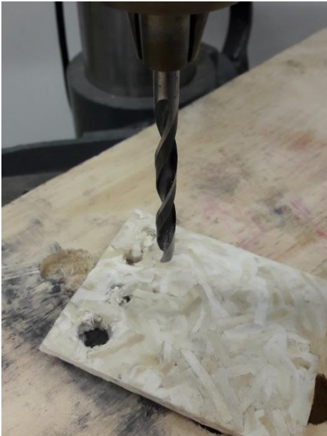
Figura n°56 “Perforación Taladro Pedestal” (Elaboración Propia).
