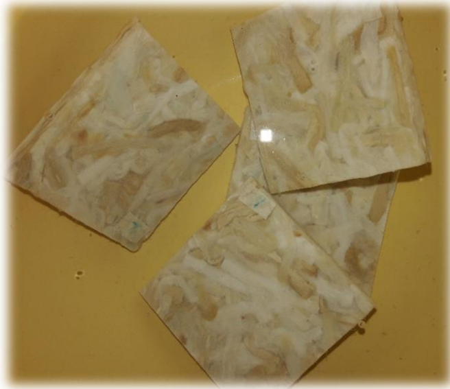
Figura n°50 “Prueba de absorción de agua e hinchamiento durante 24 horas” (Elaboración Propia).
