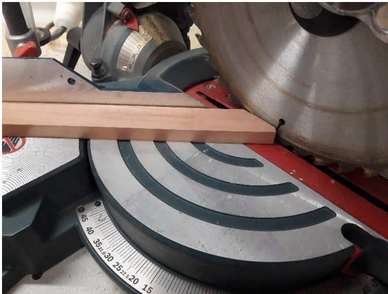
Figura nº 101: "Corte 45° con máquina ingletadora" (Elaboración Propia).
