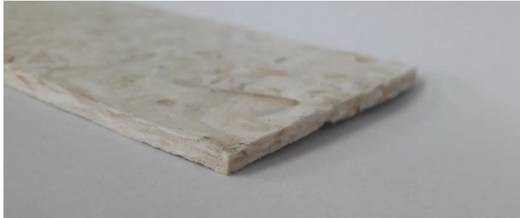
Figura n°55: "Prueba de corte manual con cúter" (Elaboración Propia).
