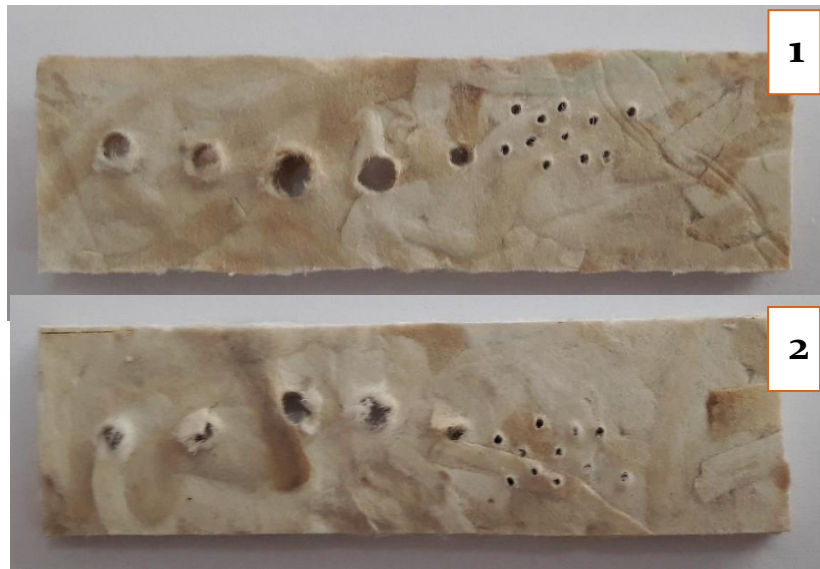
Figura n°59: “Resultados Taladro Manual (1: cara frontal – 2: cara posterior)” (Elaboración Propia).
