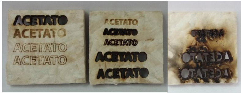
Figura n°51: “Prueba de corte, rasterizado y grabado láser” (Elaboración Propia).
