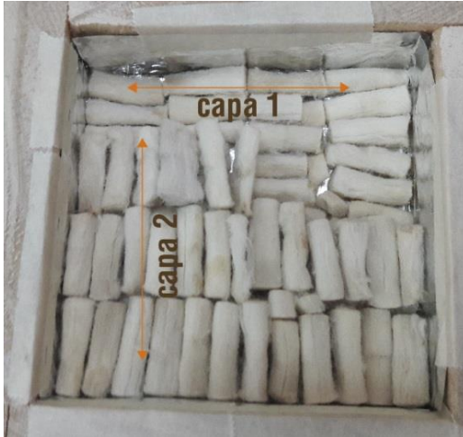
Figura n°42: "Orientación de los filtros ( 0^\circ - 90^\circ )" (Elaboración Propia).
