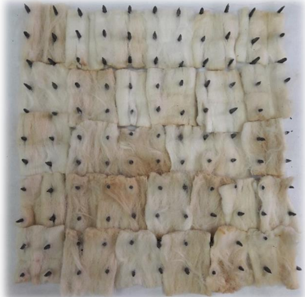
Figura nº34: "Filtros sobre cama de clavos" (Elaboración Propia).
