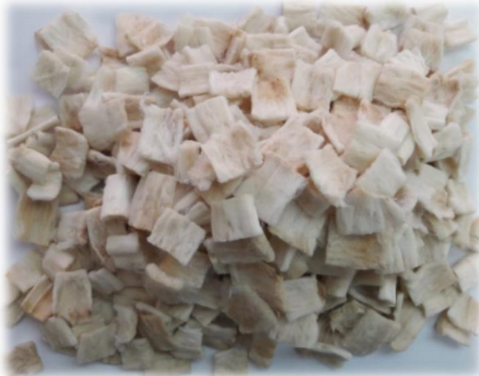
Figura n°32: "Filtros desinfectados y deshilachados" (Elaboración Propia).
