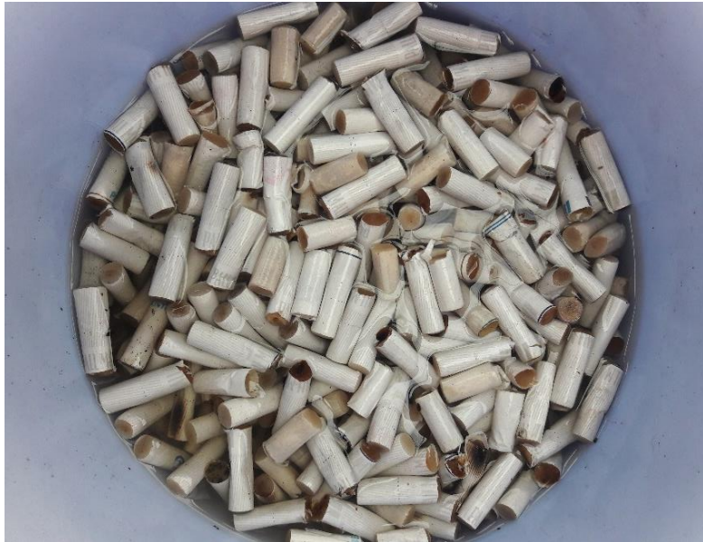
Figura n°24: “Colillas sumergidas en concentración de etanol al 95%” (Elaboración Propia).
