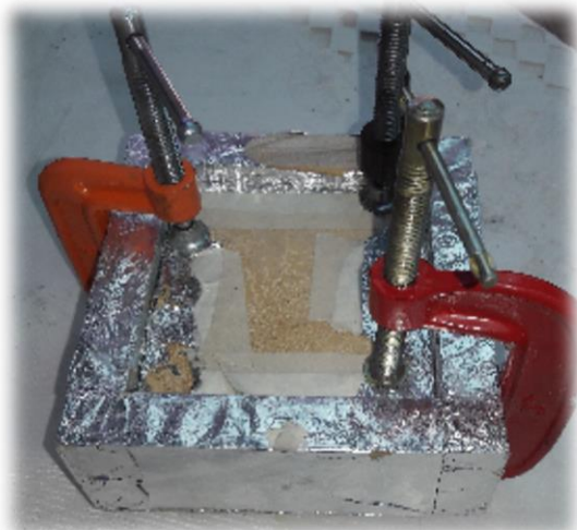
Figura n°43: "Prensado del compuesto durante 24 horas" (Elaboración Propia).
