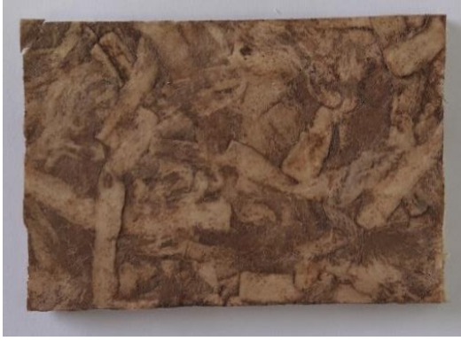
Figura n°79: “Teñido tinte para madera extracto de nogal” (Elaboración Propia).
