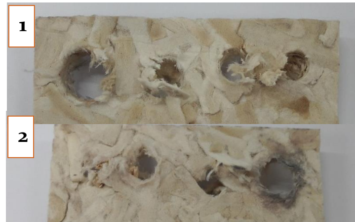
Figura n°58: “Resultados Taladro Pedestal (1: cara frontal - 2: cara posterior)” (Elaboración Propia).
