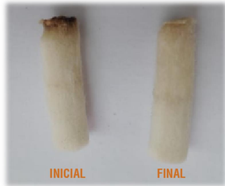
Figura n°28: "Comparación de filtros: filtro Inicial - filtro limpiado" (Elaboración Propia).
