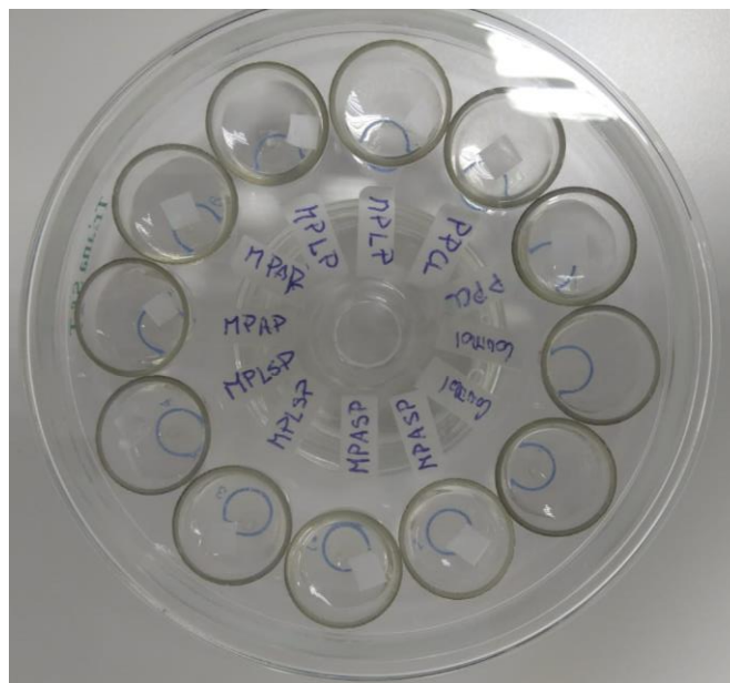
Figura 2: Vista superior de la cámara de cristalización de \text{CaCO}_3 utilizada en el método de difusión de gases.
