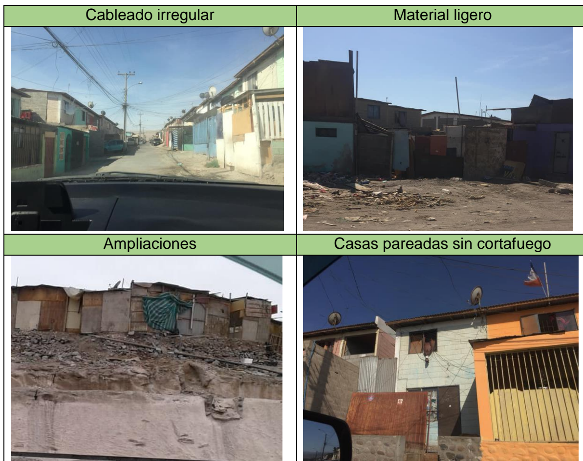
Figura 24: Características de las viviendas y cableado irregular. Fuente: Elaboración y fotografías propias, diciembre 2018
