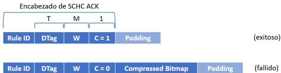
Figura 2.8: Formato de mensajes SCHC ACK para Integrity Check exitoso y fallido
