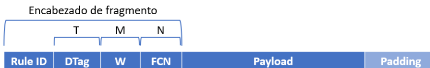
Figura 2.6: Formato detallado de SCHC Fragment
