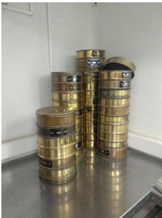
**Figura 20.** Tamices con mallas en la norma A.S.T.M del laboratorio de Sedimentología de la Universidad de Chile.
