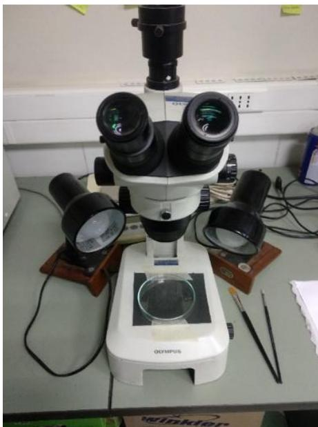
**Figura 23.** Lupa binocular Olympus del laboratorio de Sedimentología de la Universidad de Chile
