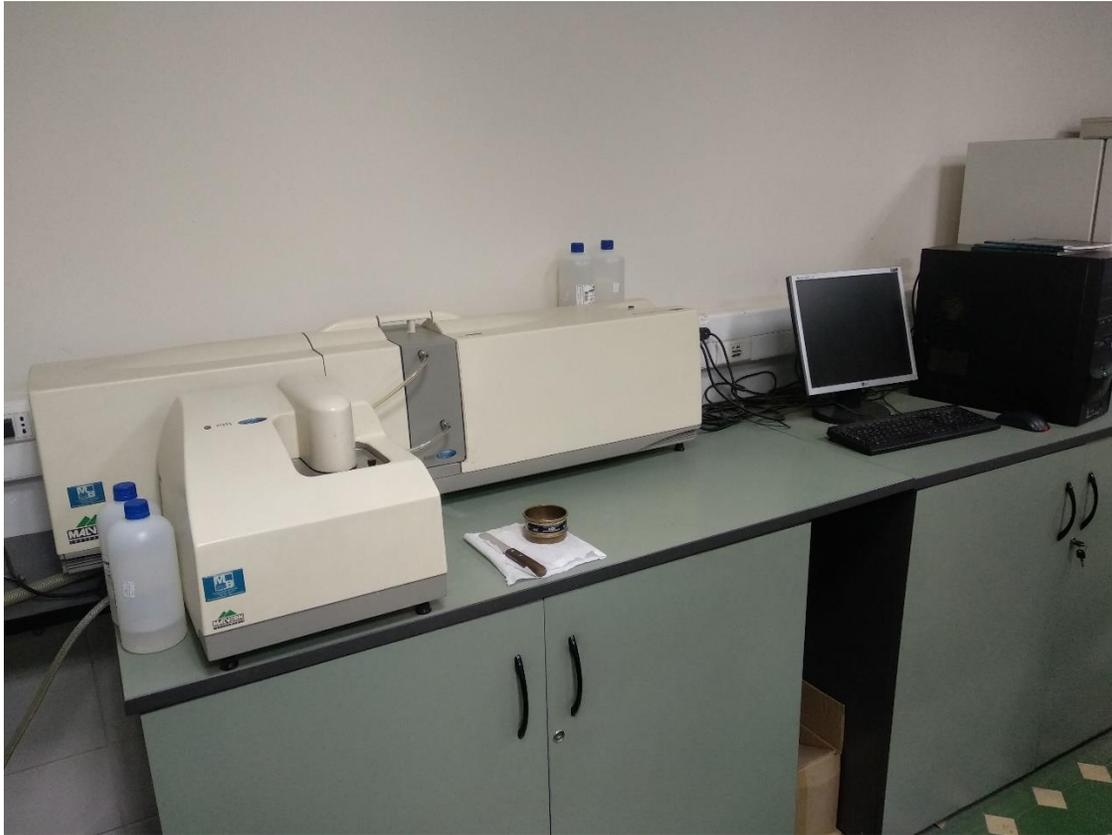
**Figura 22.** Equipo MasterSizer 2000 del laboratorio de Sedimentología de la Universidad de Chile.
