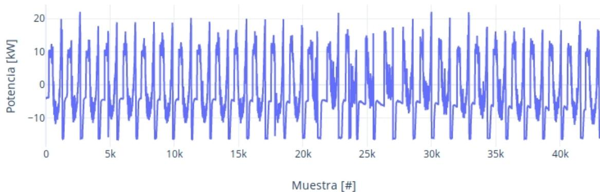
Figura 3.4: Potencia entregada y consumida de las baterías en la red.
