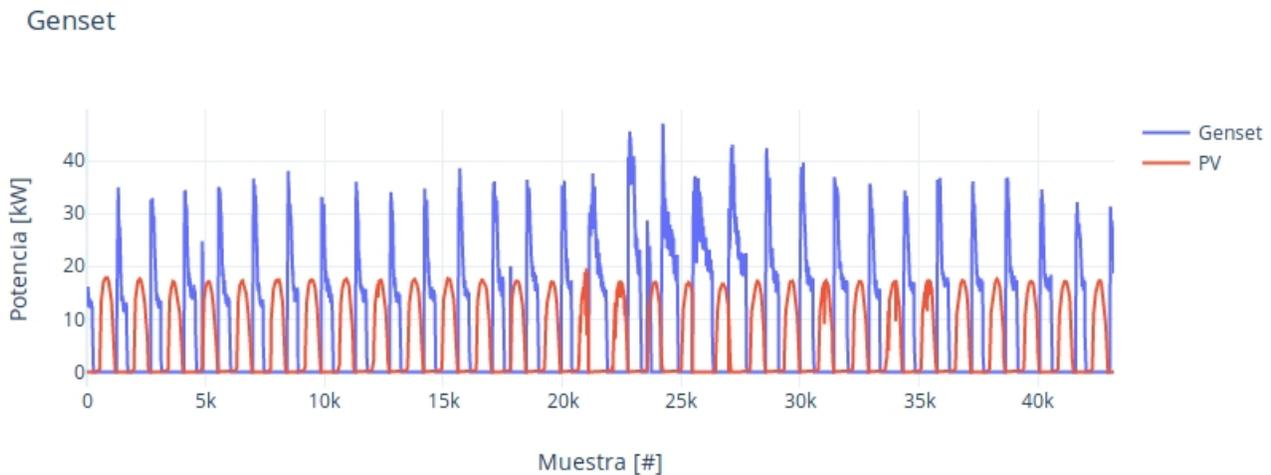
Figura 3.5: Potencia entregada por el generador diesel superpuesta con la potencia generada de los paneles fotovoltaicos.
