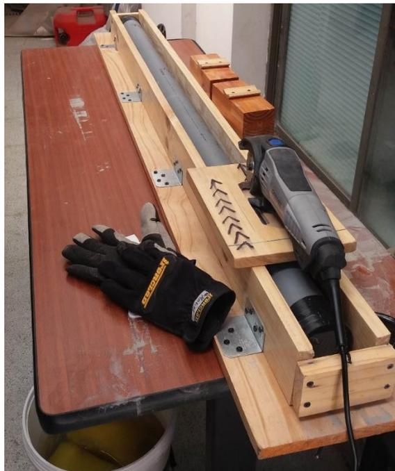
Figura 4.5: Materiales para la apertura de los testigos. Foto propia.
