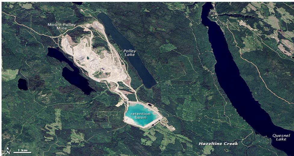
Ilustración 104: Operación MP previo a rotura de tranque de relave
