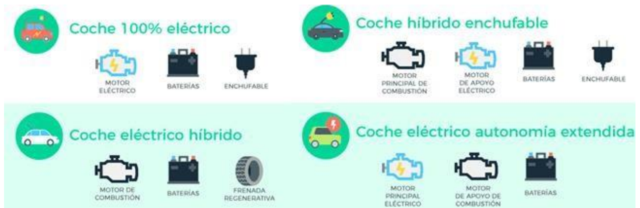
Ilustración 3: Tipos y características de vehículos eléctricos.
