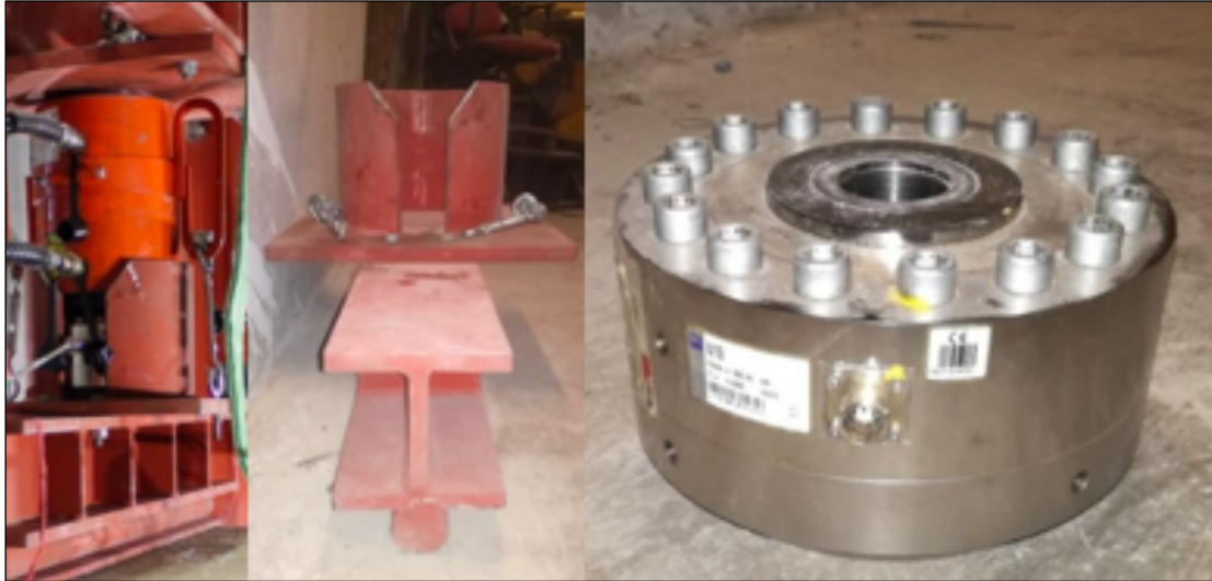
Figura 3.16. Viga de transferencia, manto cilíndrico y celda de carga.
