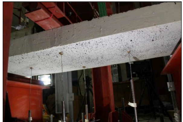
Figura 3.20. Sensores dispuestos en la superficie inferior de la losa.
