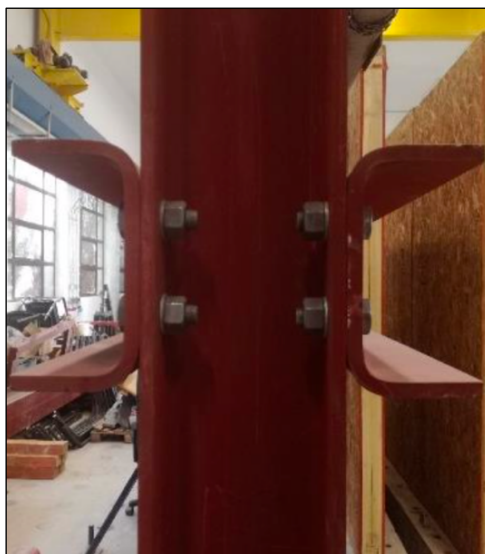
Figura 3.14. Viga doble canal.
