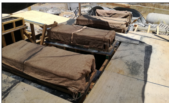
Figura 3.9. Curado de probetas.
