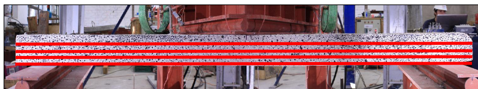
Figura 6.36. Representación gráfica de las zonas donde se obtienen las deformaciones unitarias horizontales.
