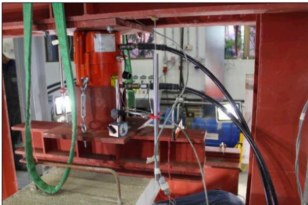
Figura 3.19. Sensores dispuestos en la superficie superior de la losa.
