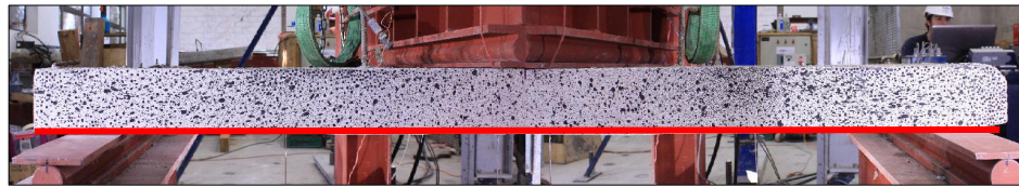
Figura 6.27. Representación gráfica de la zona en donde se obtienen las deformaciones unitarias horizontales.
