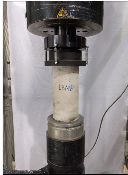
Figura 3.3. Muestra del hormigón ensayada proveniente de L3ME.
