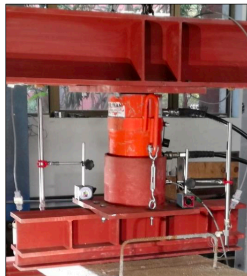
Figura 3.15. Gato hidráulico conectado a viga de transferencia.
