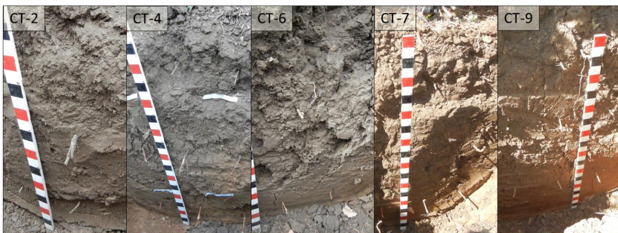
Figura 4.26 Calicatas CT-2, CT-4, CT-6, CT-7 y CT-9, mostrando horizonte C arcilloso que proviene de la meteorización de la arenisca de grano medio; horizontes superiores intervenidos. Cuartel Terraza, viña de San Antonio.
