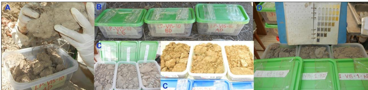
Figura 2.11. (A) Muestreo de terrones. (B) Embalaje de muestras para análisis físico y químico de suelos. (C) Muestras de los tres horizontes. (D) Tabla Munsell para determinación de color de suelos.
