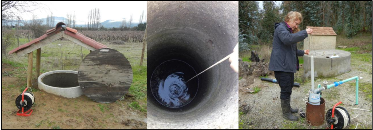
Figura 2.6. Medición de nivel freático en pozos con un pozómetro y muestreo de agua subterránea utilizando un colector Bailer.
