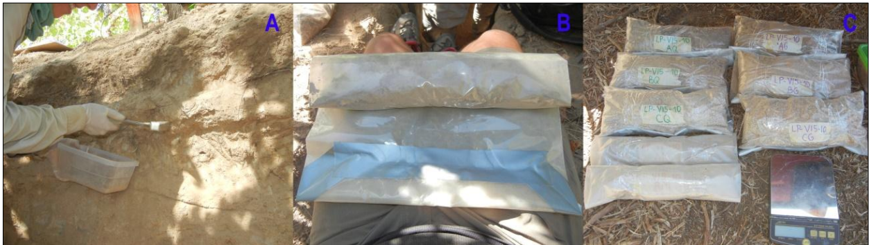
Figura 2.10. Muestreo de suelo para análisis geoquímico total en todos los horizontes o niveles. (A) Muestreo con martillo y recipiente de plástico. (B) Modo de embalaje de muestras. (C) Total de muestras de suelo tomadas en todas las calicatas en temporada Verano de 2015.
