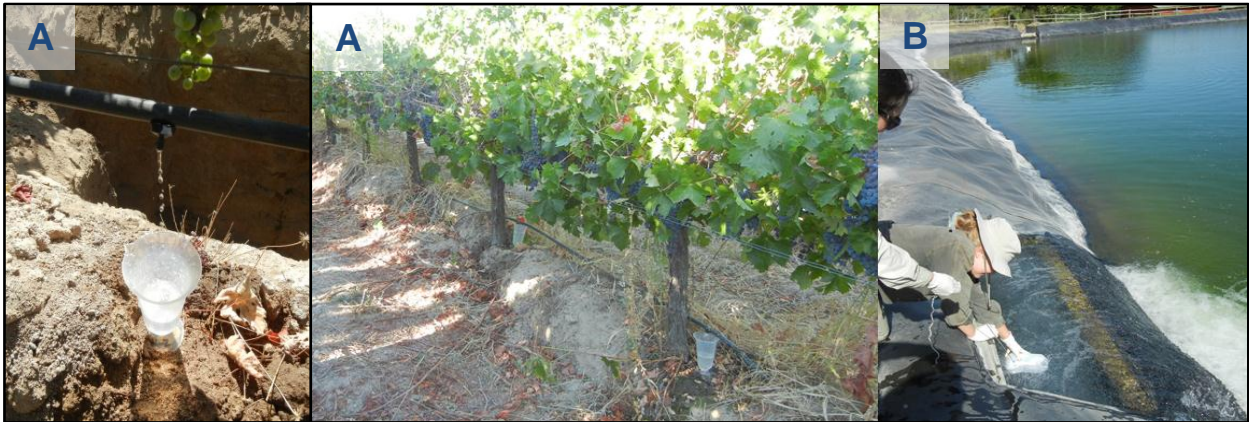
Figura 2.15. Muestreo de aguas de riego desde goteros y desde tranques.
