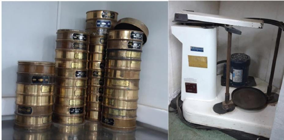
*Figura 3: Implementos utilizados en el laboratorio de Sedimentología. A la izquierda los tamices de norma A.S.T.M. y a la derecha el agitador de tamices.*
