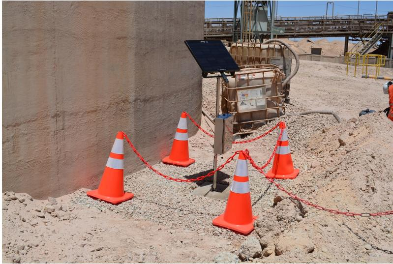
Figura 4.2: estación sismológica 105 ubicada en Silo 1 de la planta.
