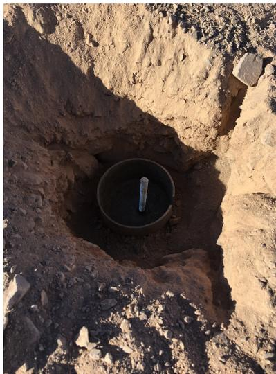
Figura 4.9: Instalación del geófono.
