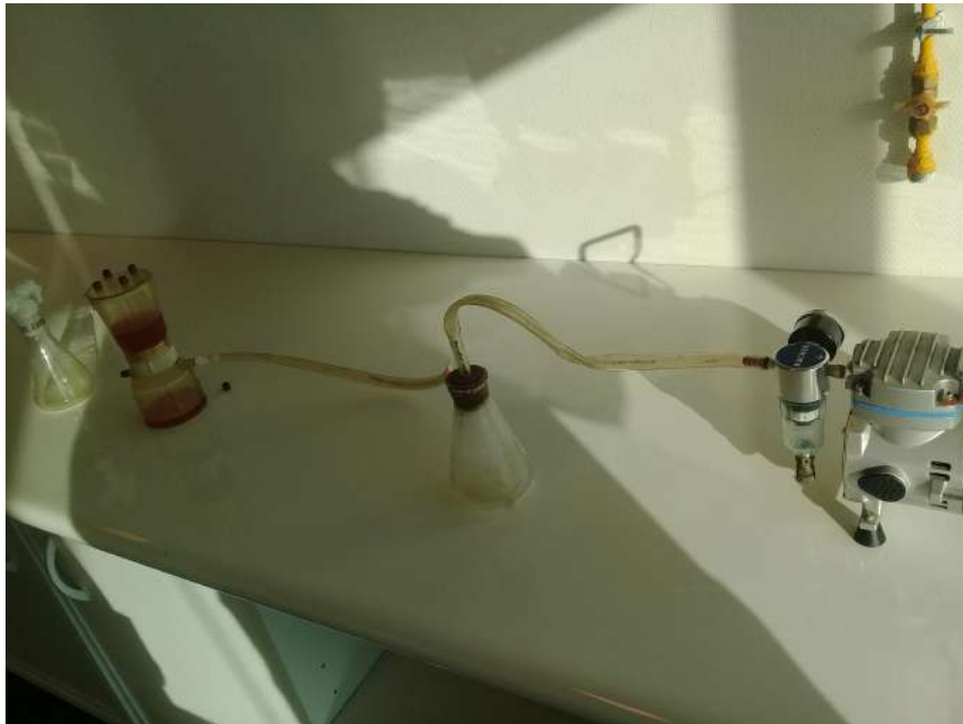
Figura 6.5: Método de filtrado de bacterias A. ferrooxidans
