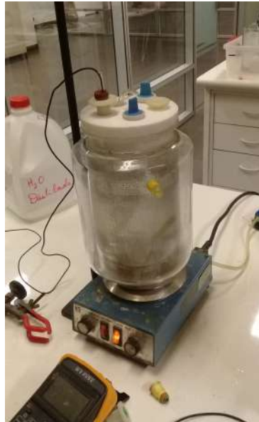
Figura 3: Reactor bioelectroquímico piloto abierto de 2000 ml
