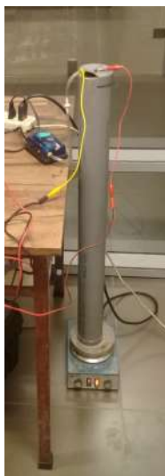
Figura 6: Reactor bioelectroquímico piloto cerrado de 3500 ml
