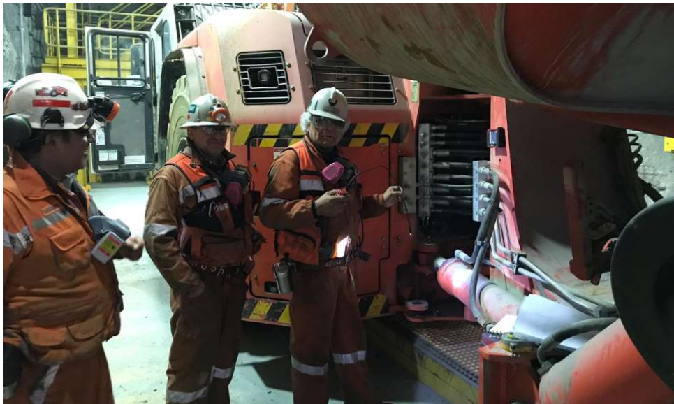
Figura 5.3: Visita a taller para revisión interna del chasis en búsqueda de planchas de refuerzo, verificación de dimensiones y obtención de espesores de planchas.
