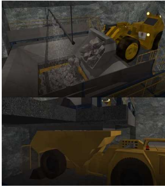
Figura 3.3: Carguío de un camión al interior de la mina mediante un pique de traspaso.
