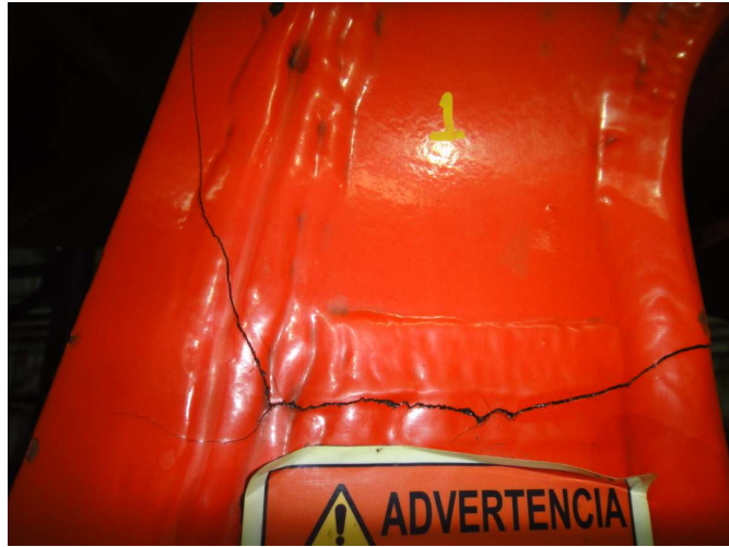
Figura 3.5: Falla en la región del soporte delantero superior que une mediante una rótula el chasis trasero con el delantero.
