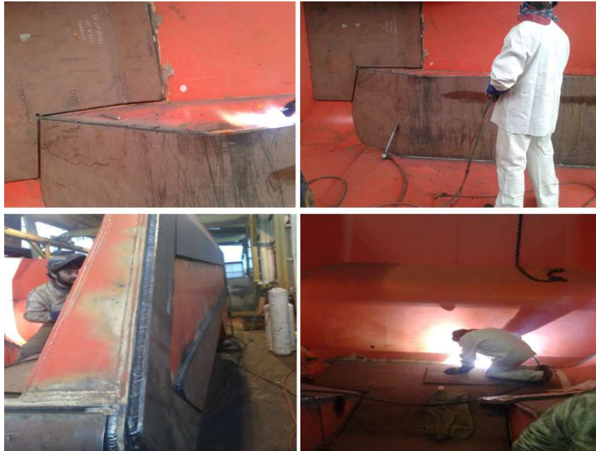
Figura 5.11: Planchas de refuerzo en la tolva que usaba el camión en el que se realizó la medición.
