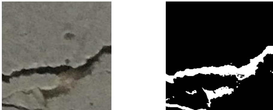
Figura 8.1: Anexo: Encoder-Decoder with Skip Óptimo: Grieta real junto a grieta segmentada
