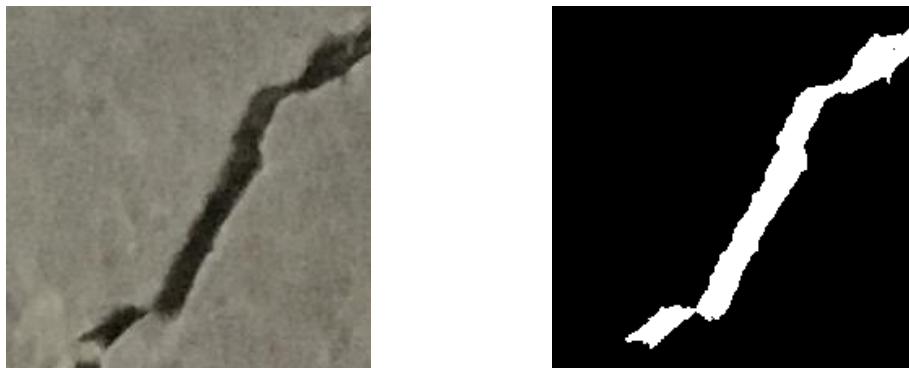
Figura 8.2: Anexo: Encoder-Decoder with Skip Óptimo: Grieta real junto a grieta segmentada
