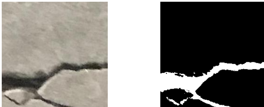
Figura 4.32: Encoder-Decoder with Skip Óptimo: Grieta real junto a grieta segmentada 5
