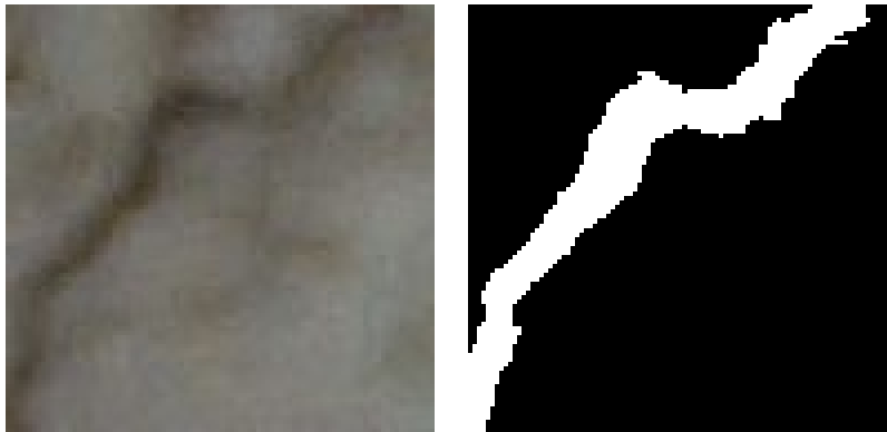
Figura 4.4: Ensayo 2: Grieta real junto a grieta segmentada
