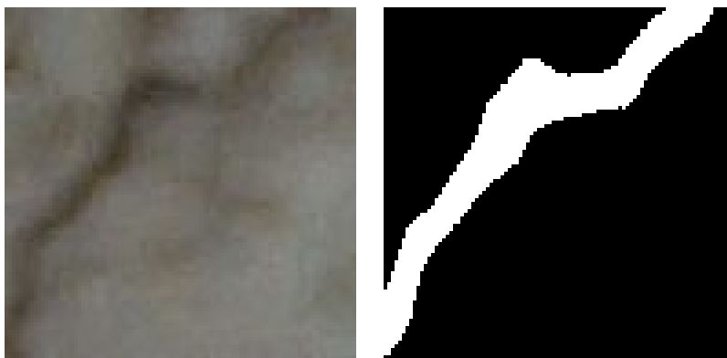
Figura 4.9: Ensayo 7: Grieta real junto a grieta segmentada
