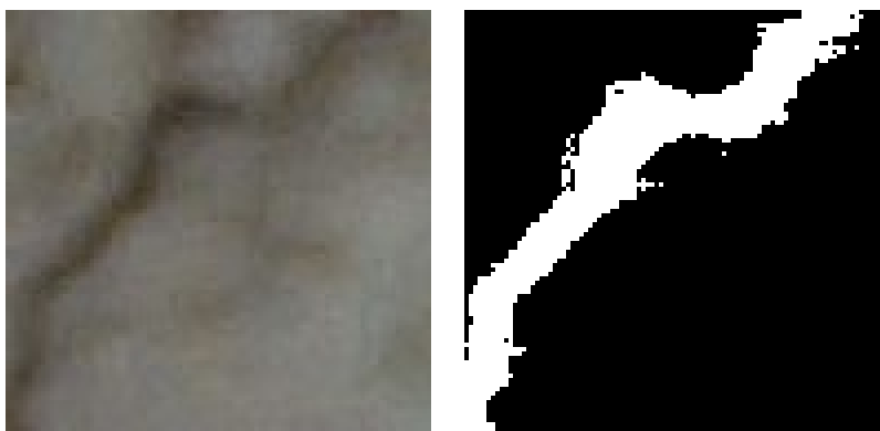
Figura 4.22: Ensayo 2: Grieta real junto a grieta segmentada
