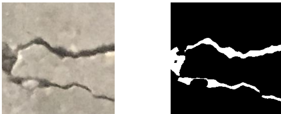
Figura 4.42: DeepLabV3+ Óptimo: Grieta real junto a grieta segmentada 6
