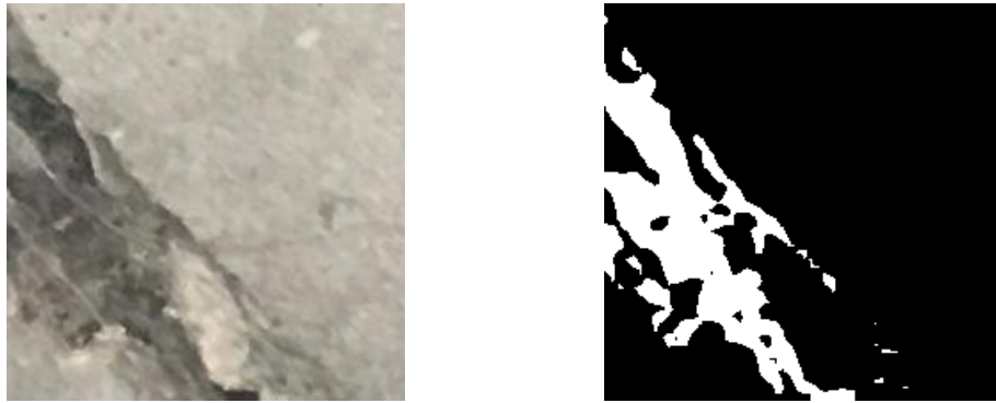
Figura 4.38: DeepLabV3+ Óptimo: Grieta real junto a grieta segmentada 2
