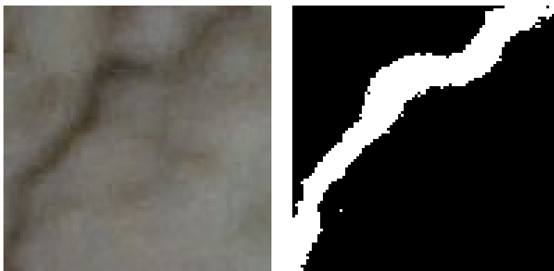
Figura 4.5: Ensayo 3: Grieta real junto a grieta segmentada
