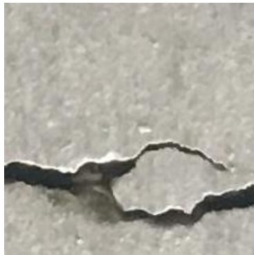
Figura 4.17: Encoder-Decoder Óptimo: Grieta real junto a grieta segmentada 3
