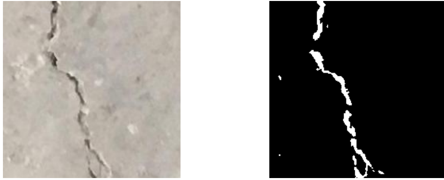
Figura 8.9: Anexo: Encoder-Decoder with Skip Óptimo: Grieta real junto a grieta segmentada
