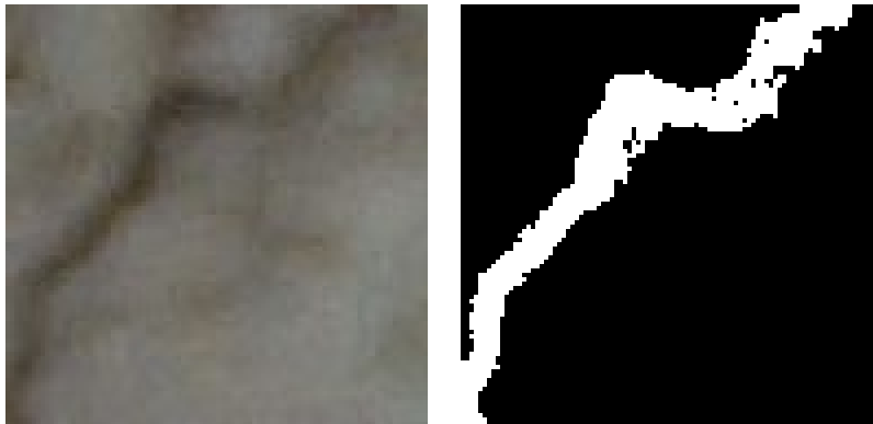
Figura 4.21: Ensayo 1: Grieta real junto a grieta segmentada
