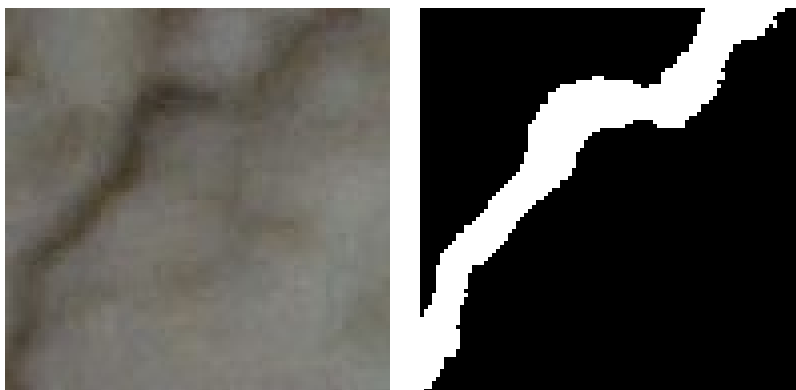
Figura 4.7: Ensayo 5: Grieta real junto a grieta segmentada
