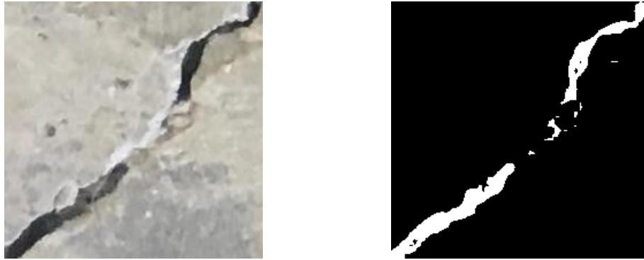
Figura 4.40: DeepLabV3+ Óptimo: Grieta real junto a grieta segmentada 4
