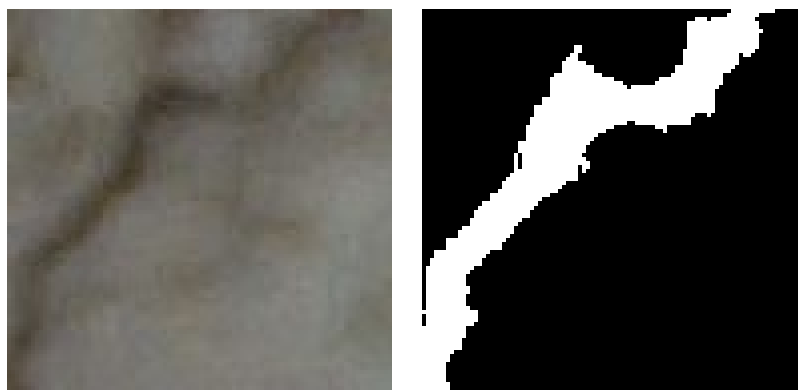
Figura 4.23: Ensayo 3: Grieta real junto a grieta segmentada
