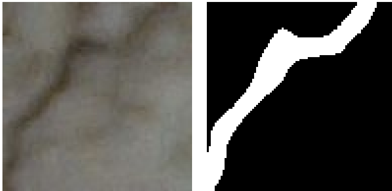
Figura 4.8: Ensayo 6: Grieta real junto a grieta segmentada
