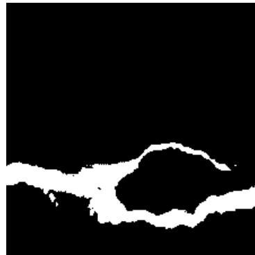
Figura 4.30: Encoder-Decoder with Skip Óptimo: Grieta real junto a grieta segmentada 3
