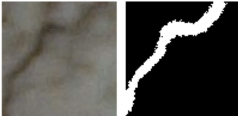
Figura 4.3: Ensayo 1: Grieta real junto a grieta segmentada
