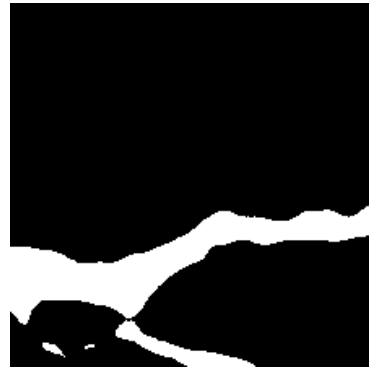
Figura 4.19: Encoder-Decoder Óptimo: Grieta real junto a grieta segmentada 5
