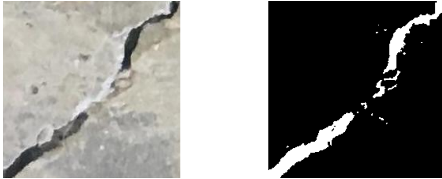
Figura 4.31: Encoder-Decoder with Skip Óptimo: Grieta real junto a grieta segmentada 4
