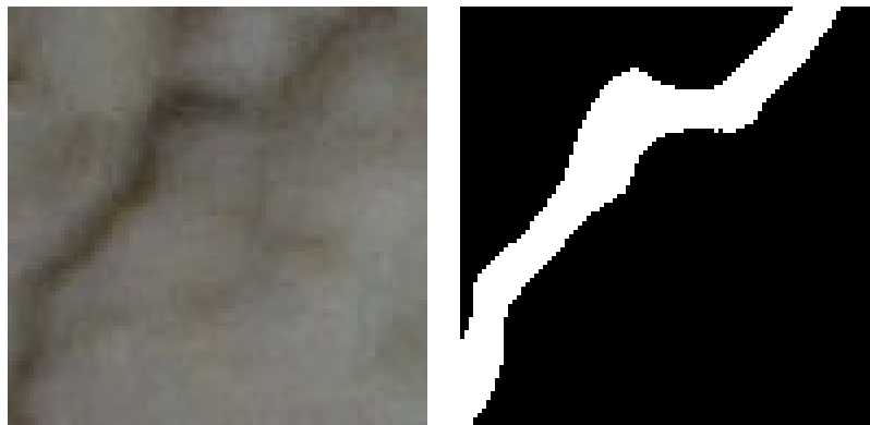
Figura 4.10: Ensayo 8: Grieta real junto a grieta segmentada
