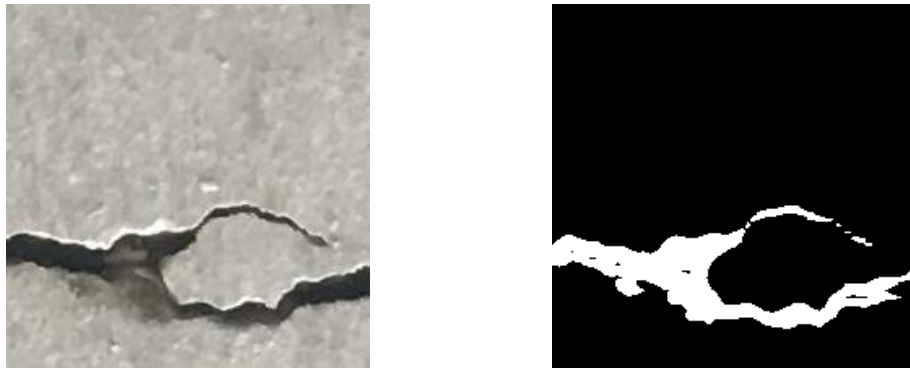
Figura 4.39: DeepLabV3+ Óptimo: Grieta real junto a grieta segmentada 3
