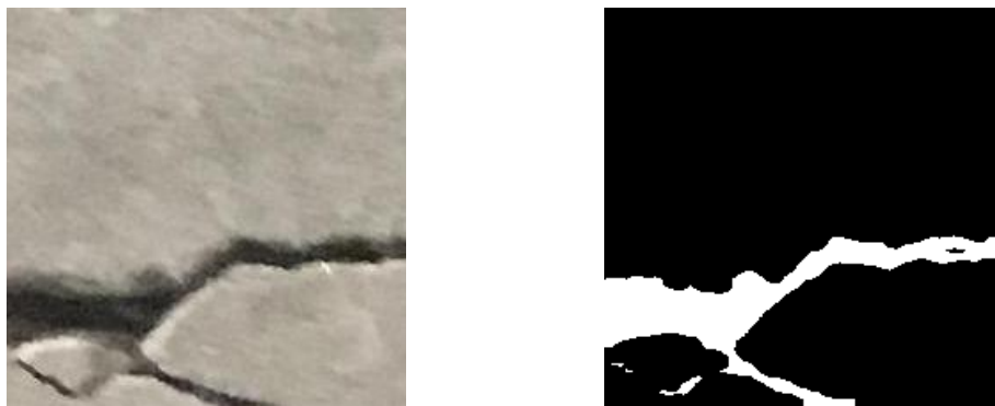
Figura 4.41: DeepLabV3+ Óptimo: Grieta real junto a grieta segmentada 5
