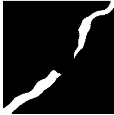
Figura 4.18: Encoder-Decoder Óptimo: Grieta real junto a grieta segmentada 4
