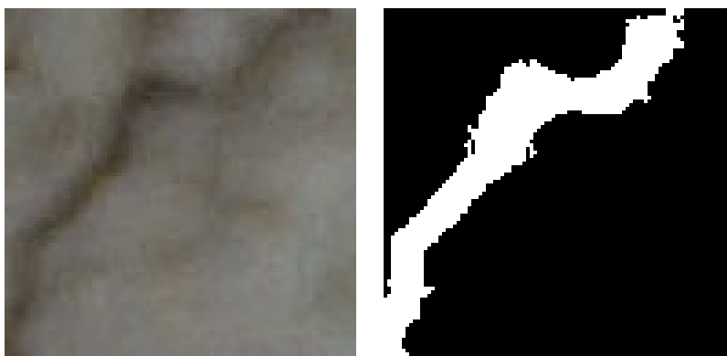
Figura 4.24: Ensayo 4: Grieta real junto a grieta segmentada
