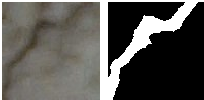
Figura 4.6: Ensayo 4: Grieta real junto a grieta segmentada
