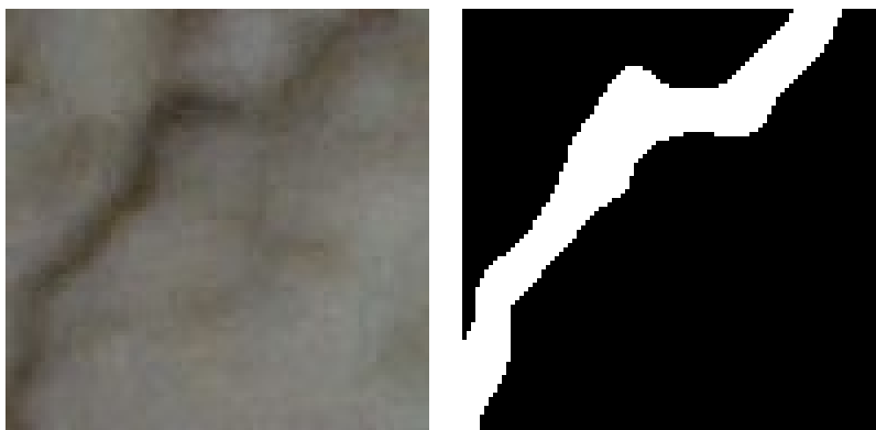
Figura 4.11: Ensayo 9: Grieta real junto a grieta segmentada
