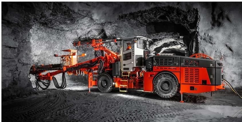
*Figura 16: Perforación de avance horizontal con equipo Jumbo (Prensa Compument)*
