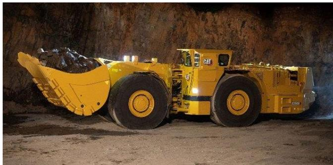
Figura 17: Extracción de marina con equipo LHD (Crane and Machinery)
