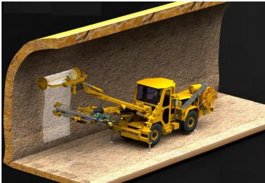
Figura 19: Equipo jumbo instalador de perno y malla (Rabajille, 2017)
