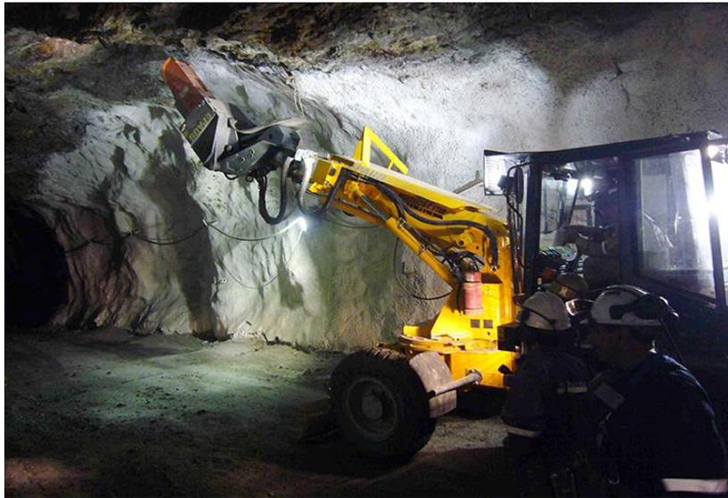
Figura 18: Acuñadura mecanizada (Induambiente)
