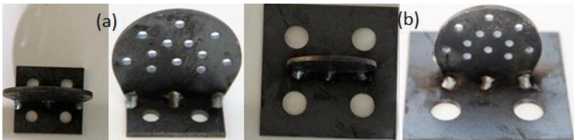
Figura 3.3. (a) Conexión universal 4cm x 4 cm. (b) Conexión Universal 8cm x 8cm. Fuente: Versluys (2017).
