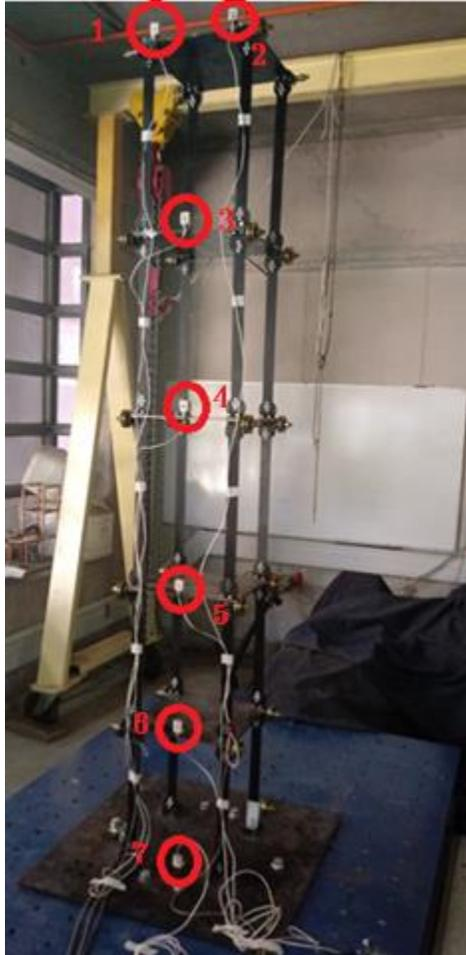
Figura 3.28. Ubicación de los acelerómetros en estructura tipo.
