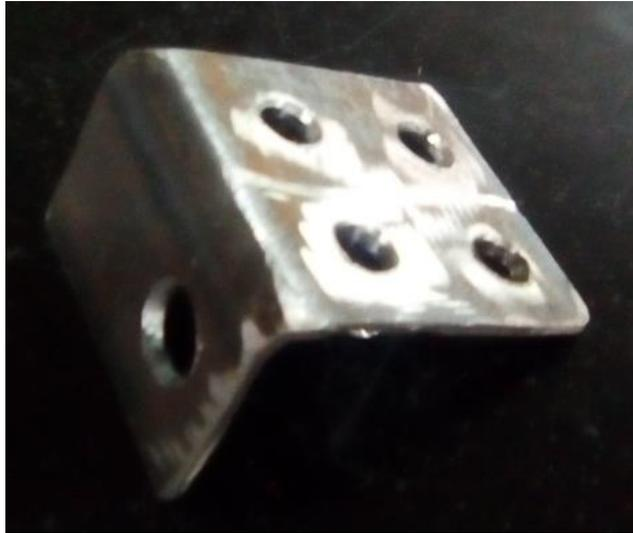
Figura 3.8. Elemento L para conexión de poleas a la estructura.
