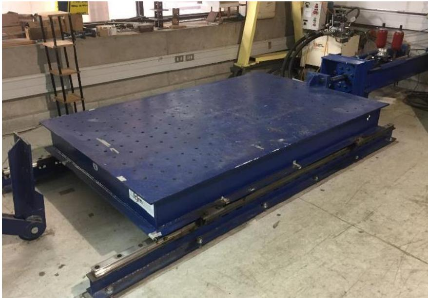
Figura 3.27. Mesa Vibradora del LEE.
