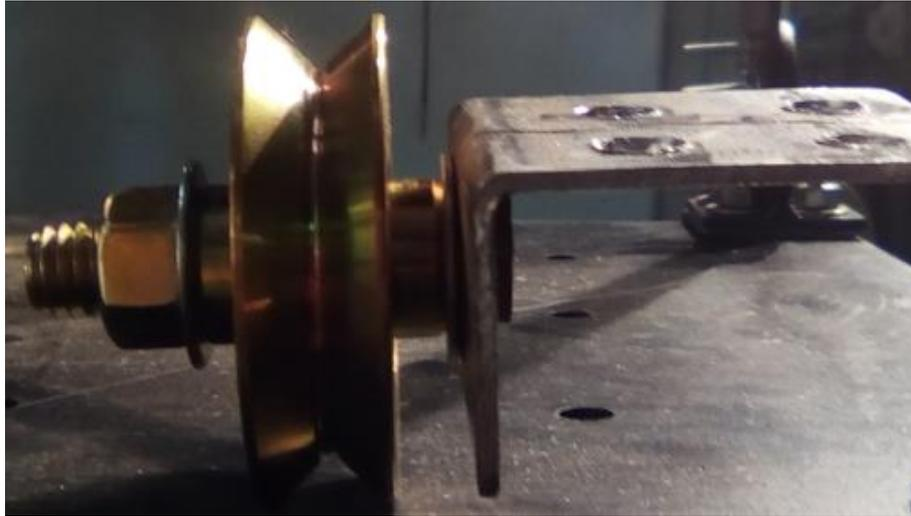
Figura 3.10. Conexión del elemento “L” con el eje de la polea.
