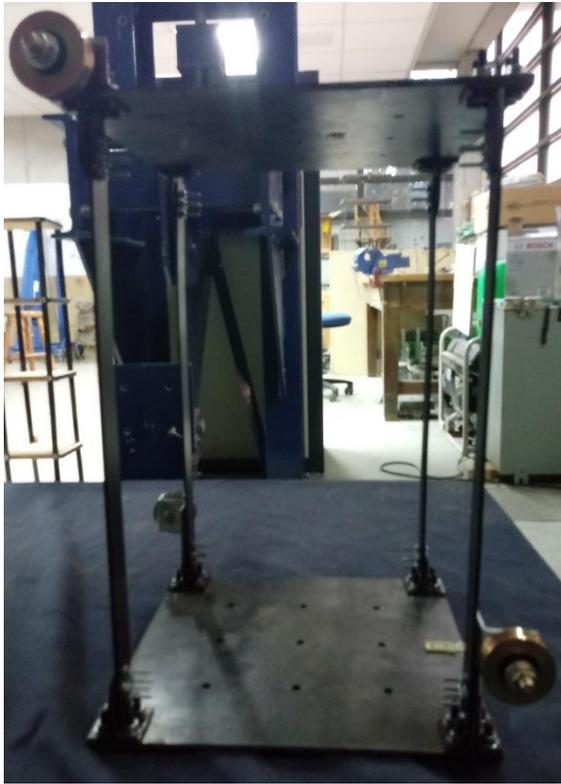
Figura 3.15. Estructura sin Disipadores - Configuración 0A.
