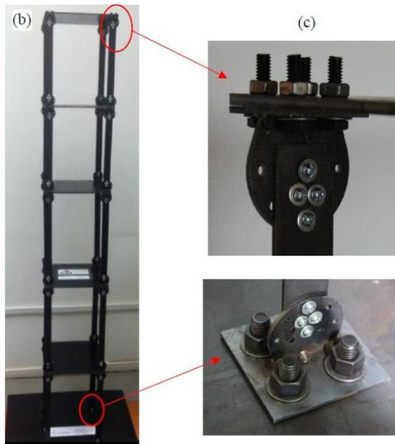
Figura 3.4. Vista a conexiones columna-losa y columna-placa de conexión. Fuente: Versluys (2017).
