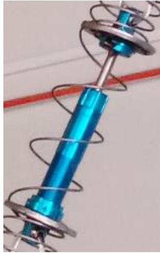
Figura 3.13. Amortiguador Visco-Elastico con Placas de Metal y Resorte en Retracción Metálica.
