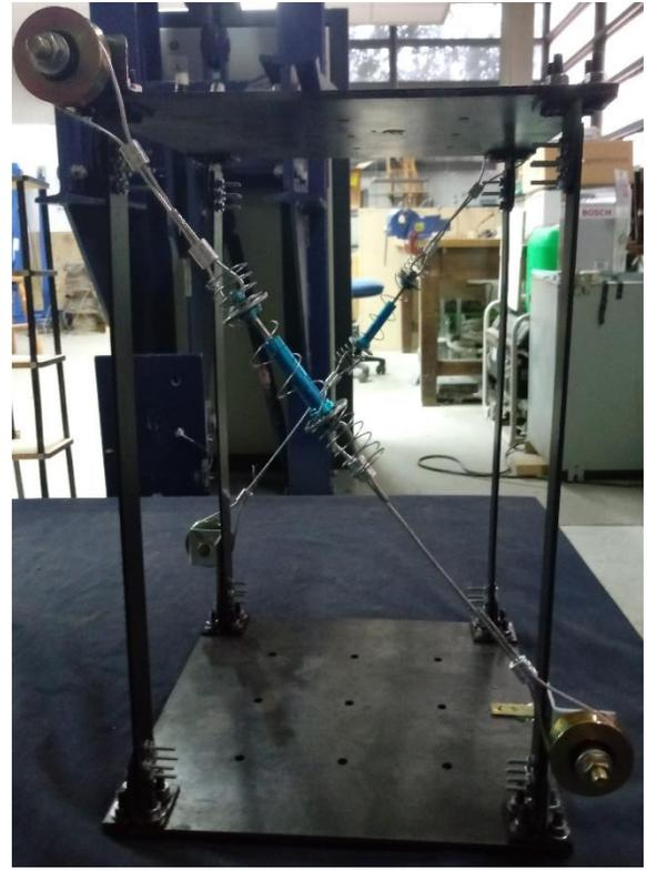
Figura 3.16. Estructura con Disipadores Tipo I - Configuración 0B.
