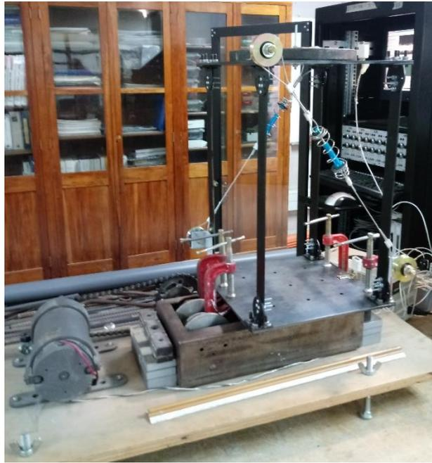
Figura 3.20. Estructura 0C sobre mesa de ensayos.
