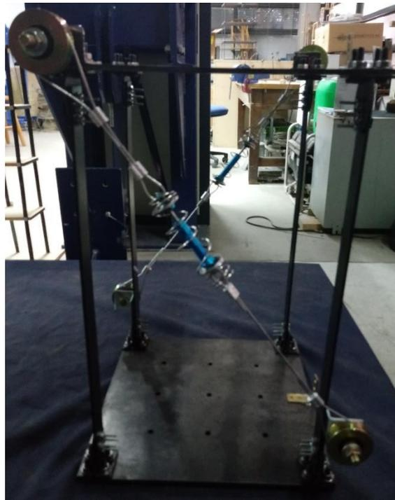
Figura 3.17. Estructura con Disipadores Tipo II - Configuración 0C.
