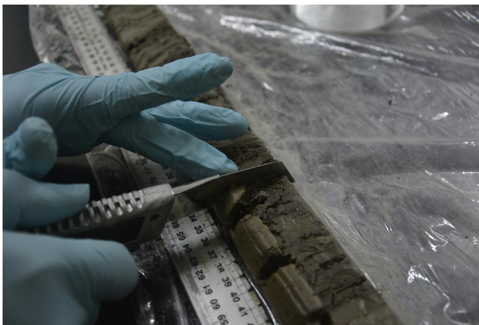
Figura 18: Proceso de Muestreo del Testigo.
