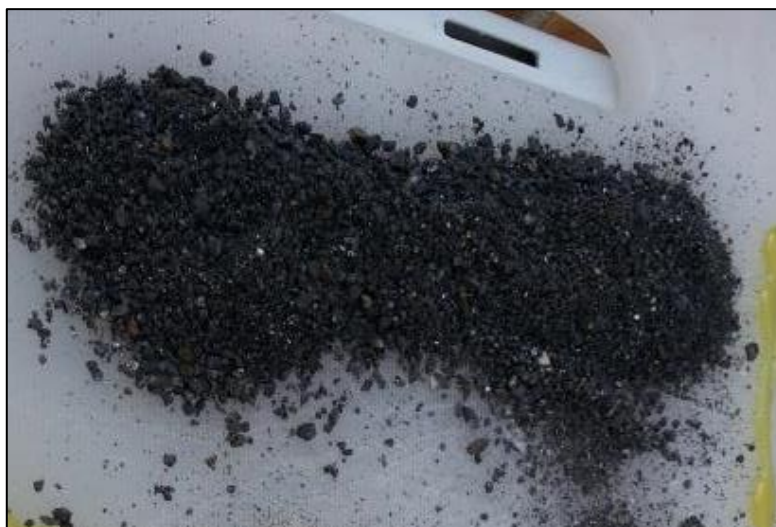
Figura 40. Experimento de geología donde se pulverizó galena y calcopirita por separado y luego se mezclaron, tomando una tonalidad oscura. Fuente: Galería de experiencias mineralógicas por Javier Rodríguez, 2010.
