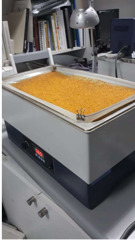
Figura 5: Sistema de secado por método de ventana de refractancia e Infrarrojo
