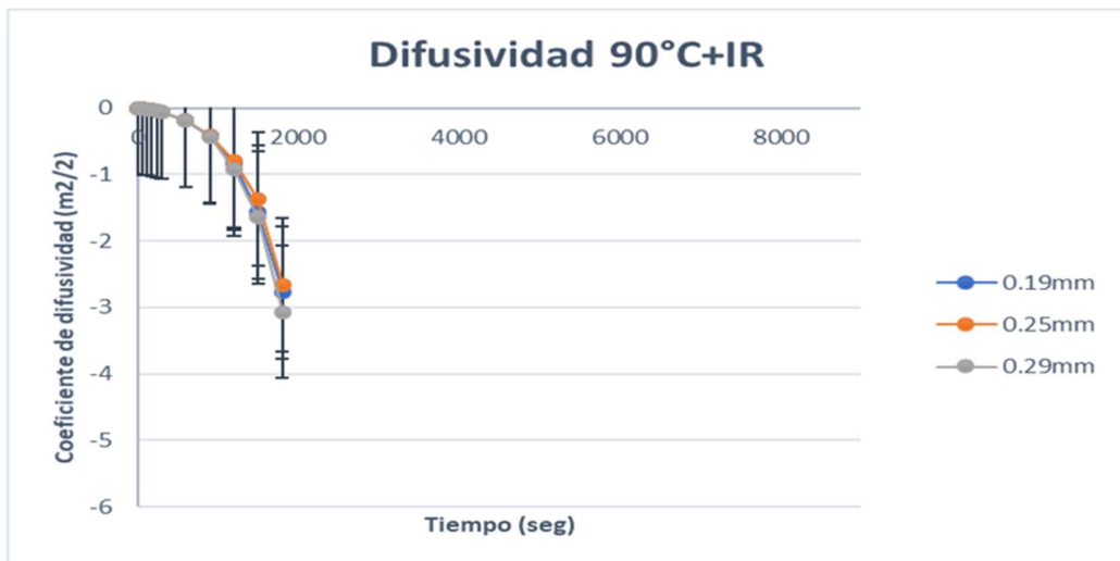
Gráfico 18: Coeficiente de difusividad a 90°C+IR con película de Mylar ® 0.19, 0.25 y 0.29mm
