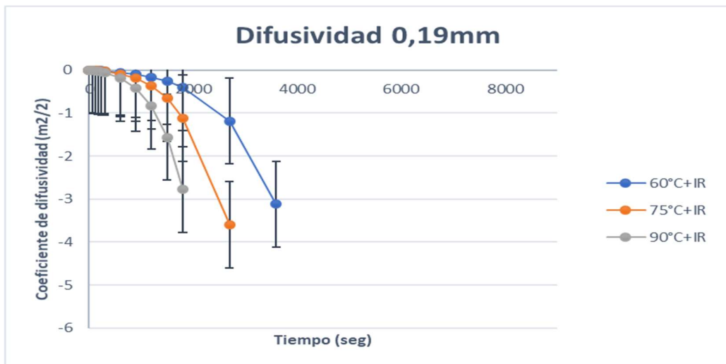
Gráfico 22: Coeficiente de difusividad con película de Mylar ® de 0.19mm a tres temperaturas distintas (60, 75 y 90°C) e IR
