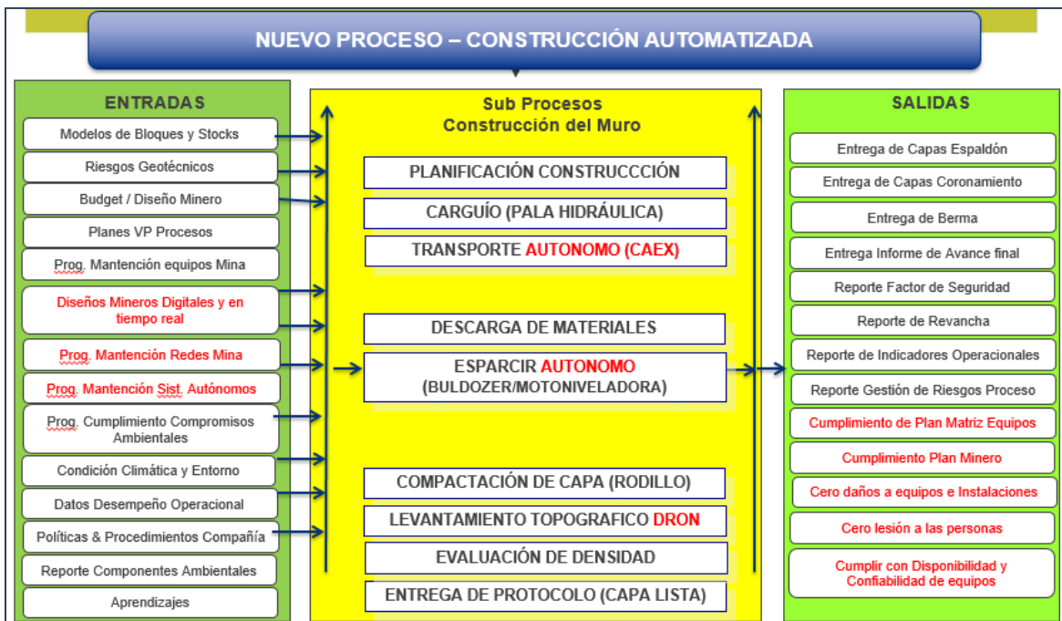
Figura 5-8 Modelo de Nuevo del Proceso - Construcción Muro de Relaves
