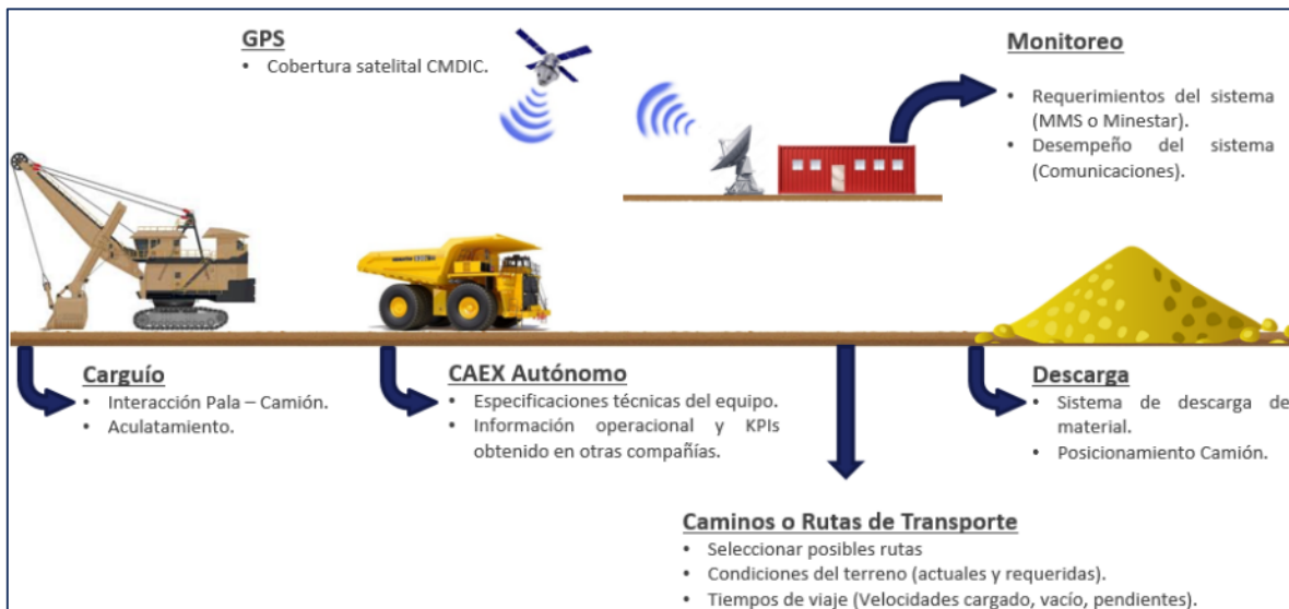
Figura 4-2 Sistema de operación de equipos autónomos
