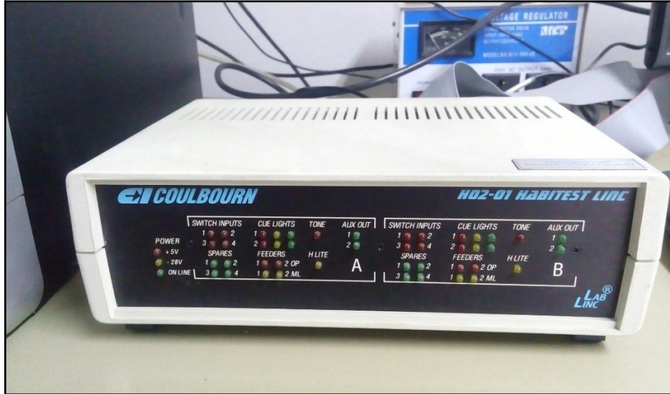
Figura 4. Fotografía del Habitest Linc. Se puede observar un tablero de luces que podía mostrar el estado de activación de dos cámaras de autoadministración (diferenciados como paneles A y B).
