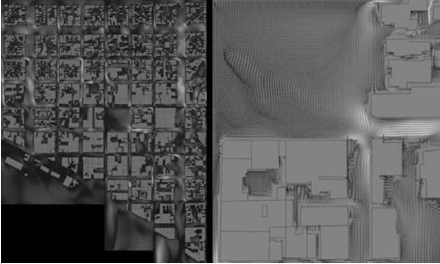
Figura 74. Dos métodos para generar los modelos de simulación. Uno a través de un CFD, o simulador de dinámicas de fluido (Autodesk Vasari), otro más detallado mediante Ecotect. Se hizo primero en bloques y después en forma general, constituyendo mediante ellos zonas de 2 x 2 cuadras. El modelo general corresponde a la suma de estos bloques, tanto en planta como en corte
