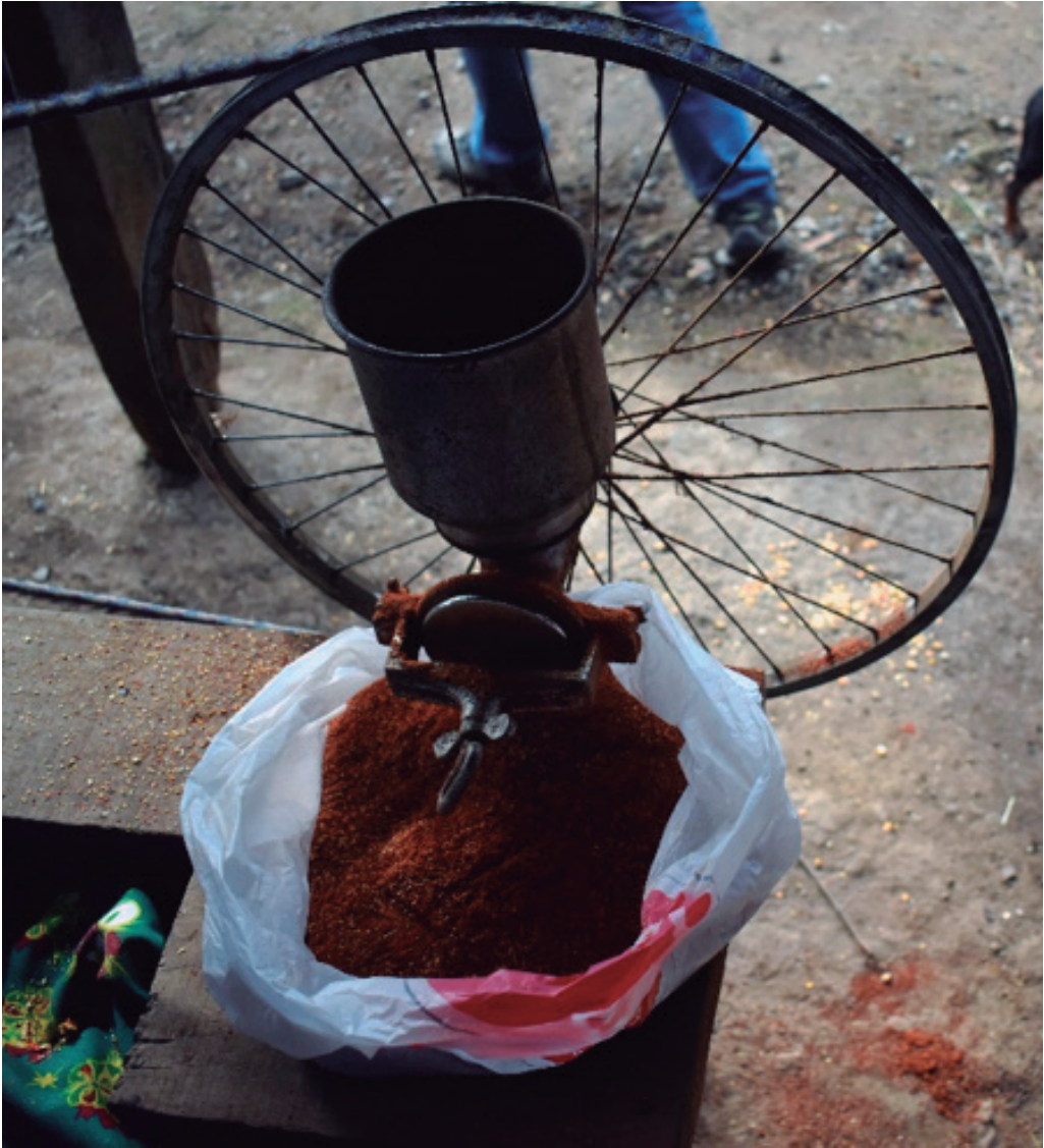
Figura 21. Molino corona con motor artesanal.
