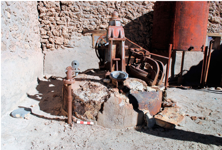
Figure 11. Japanese autoclave TAMAGAWA at the Buenaventura site. © Proyecto Arqueológico Alto Cielo.
