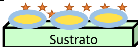
Figura 2-2: Esquema de depósito de nanopartículas recubiertas con \text{SiO}_2 . Las estrellas corresponden a la molécula luminiscente
