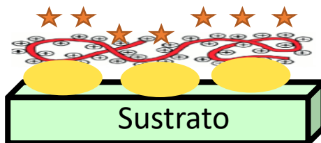
Figura 2-1: Esquema de depósito del polielectrolito positivo sobre las nanopartículas. Las estrellas corresponden a la molécula luminiscente.
