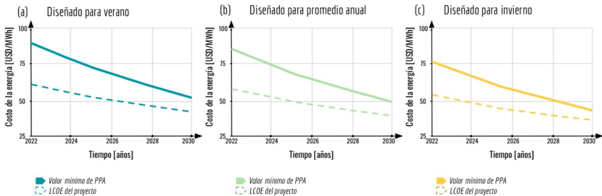
Figura 5.5: Tendencias del LCOE y del mínimo PPA para diferentes configuraciones PV-ESS
