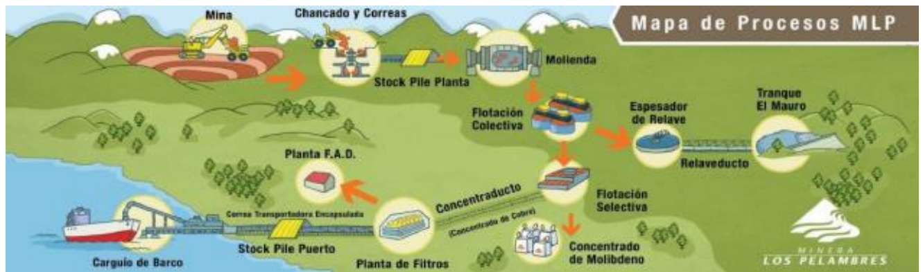
Ilustración 28: Proceso productivo de Minera Los Pelambres (Bonzi, 2016).
