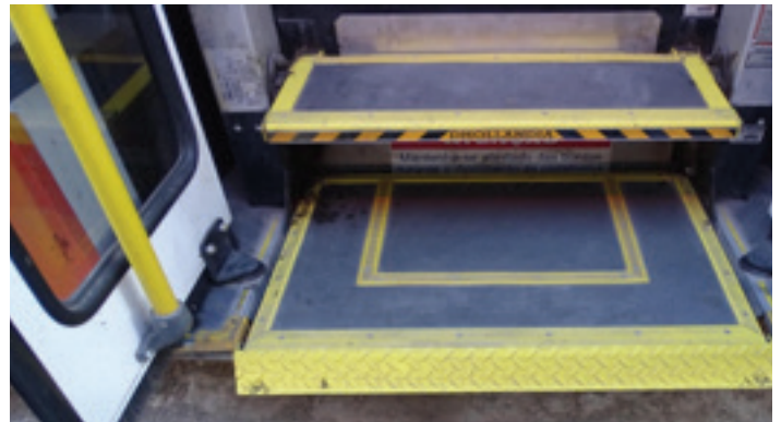
Figura 2: Plataforma para ingreso/egreso de usuarios en silla de ruedas en bus del transporte público.
