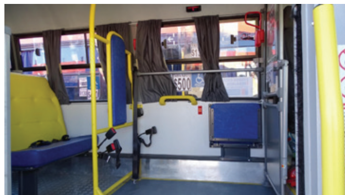
Fuente: Elaboración propia. [Descripción de imagen: Fotografía del interior de un bus de transporte público de pasajeros, se observa espacio y medios de sujeción para silla de ruedas
