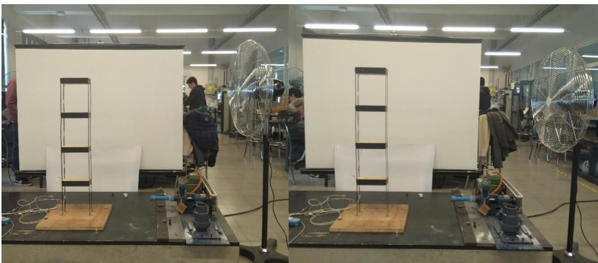
Figura 12. Configuraciones de altura de ventilador. Izquierda: Altura máxima. Derecha: Altura mínima.
