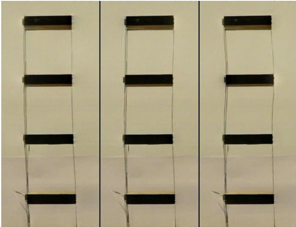
Figura 92. Formas modales estructura de laboratorio.
