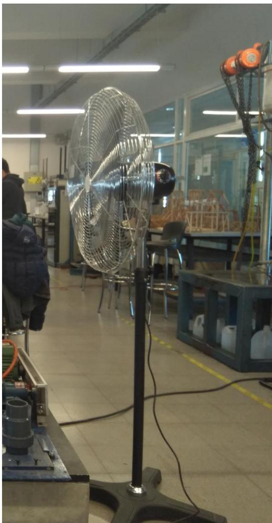
Figura 10. Ventilador usado para excitar la estructura.
