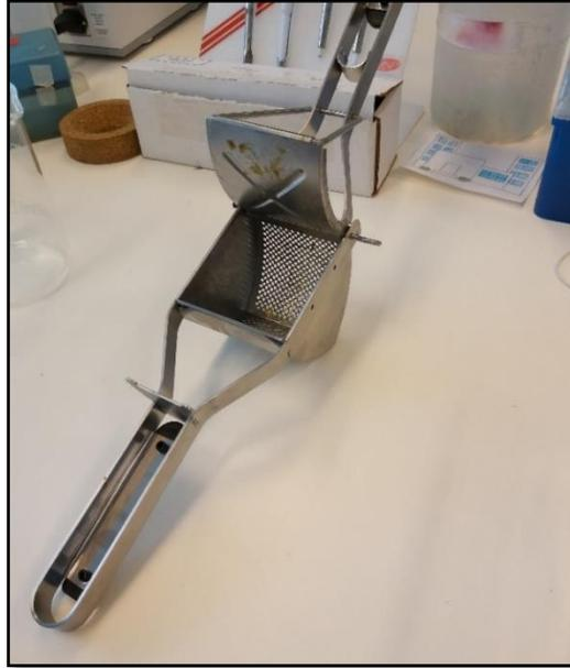
Figura 49: Prensa utilizada para filtración de agar.
