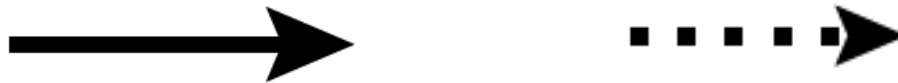
Ilustración 9: ejemplo de flujo de secuencia (a la izquierda) y mensaje (a la derecha)
