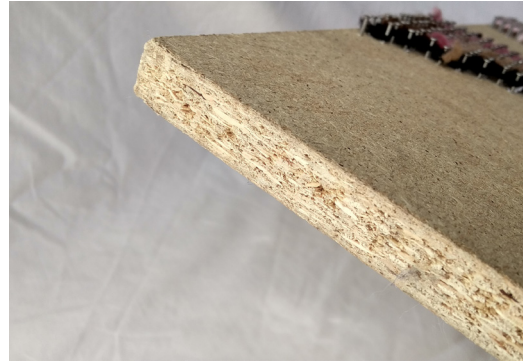
Detalle de material: madera aglomerada de 1,5 cm de espesor
