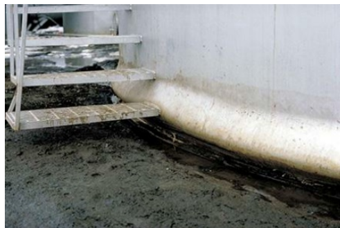
Figura 2.15: Pandeo Global (Pata de Elefante). [2]
