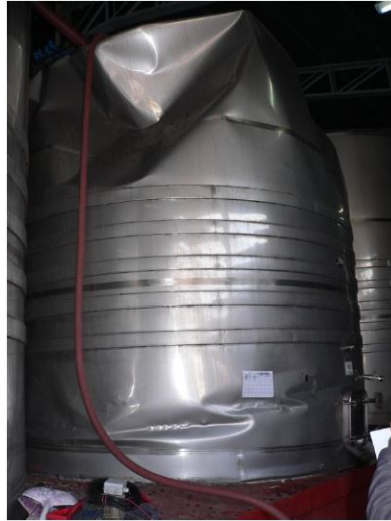
Figura 2.19: Falla por vaciado Rápido. [11]
