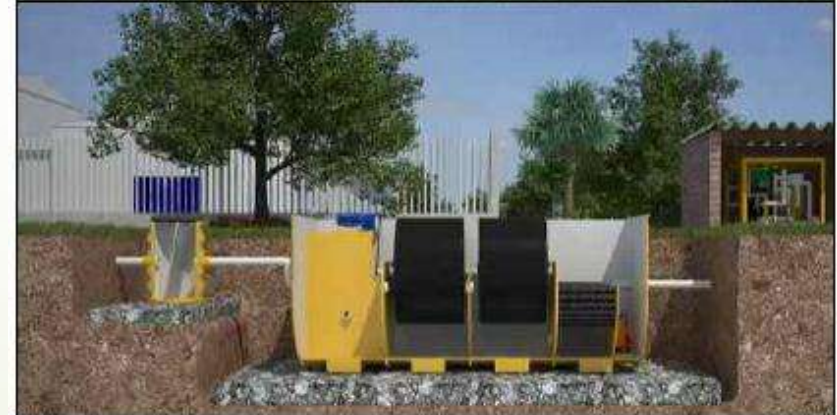
P L A N T A B I O D I S C O Excavación nivelada con grava compactada.
