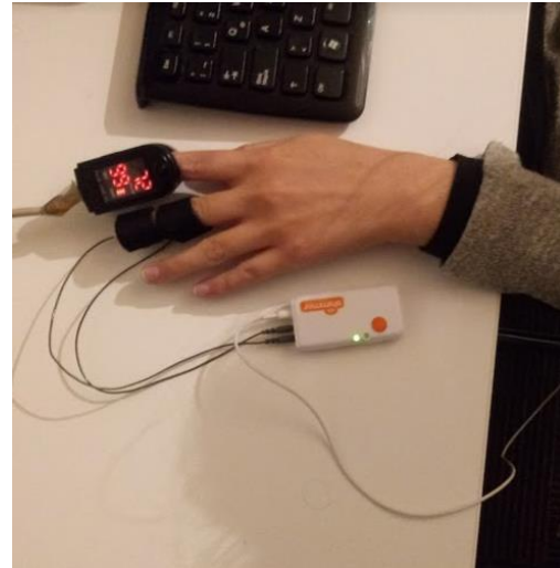
Imagen 3.11: Oxímetro de pulso instalado.
