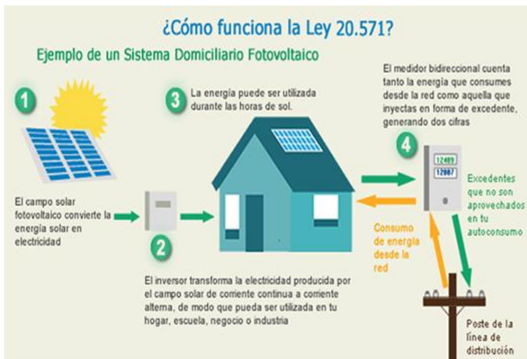
Ilustración 5. Funcionamiento de un sistema fotovoltaico y la ley 20.571
