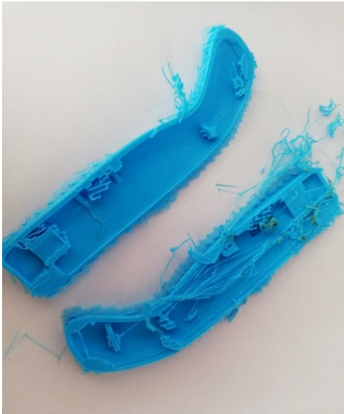
Fig. 81: Prototipo con filamento enmarañado. Fuente: Archivo de autor.
