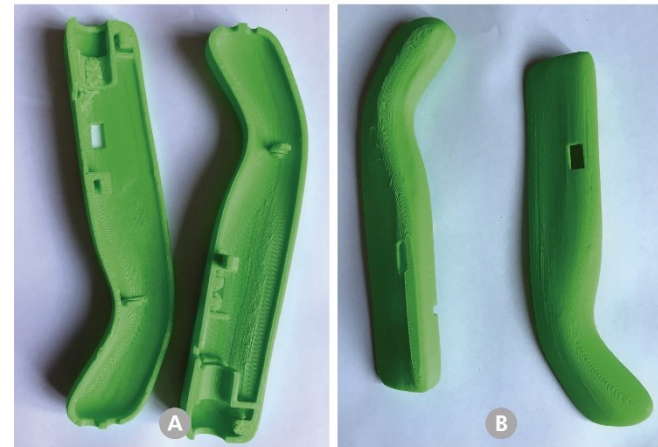
Fig. 71: Carcasa impresa en 3D: A. Interior. B. Exterior. Fuente: Archivo de autor.
