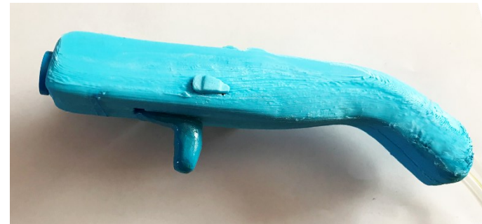
Fig. 79: Prototipo con nuevo botón cambio de función.
