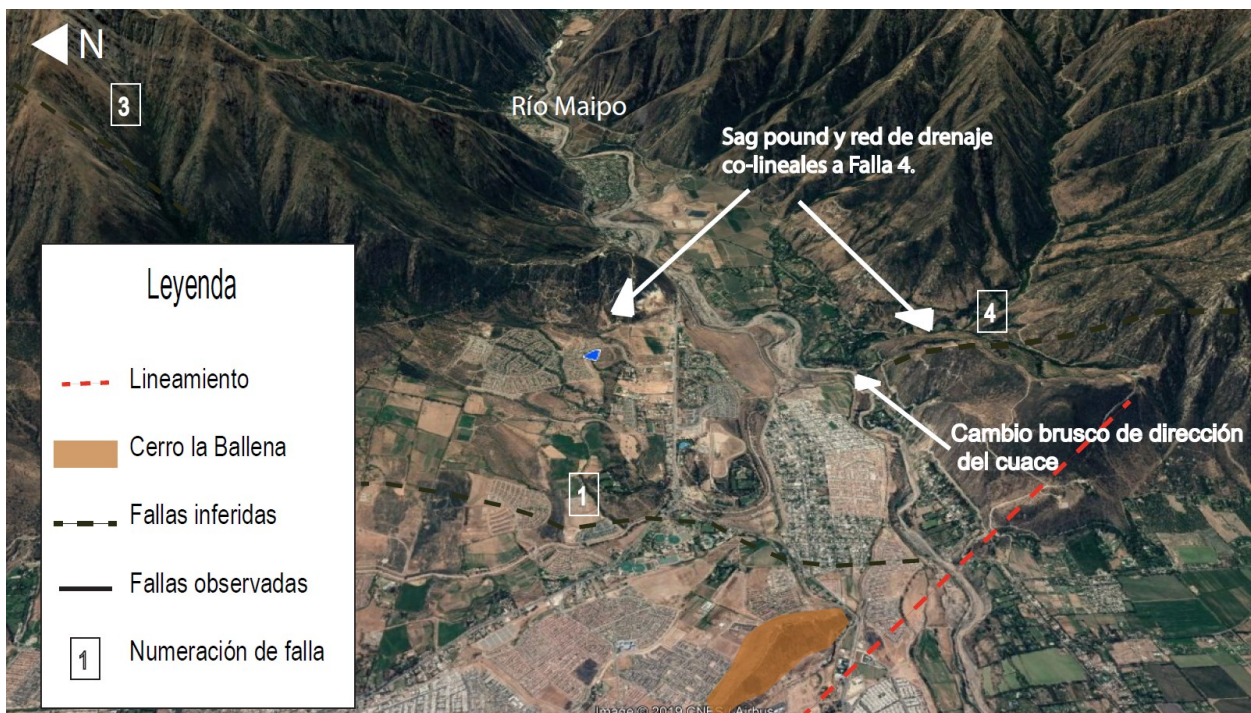
Figura 6.9: Interpretación de actividad neotectónica en la zona centro. 1. Falla San Ramón; 3. Falla 3 . 4. Falla 4. Imagen satelital extraída del programa GEP.
