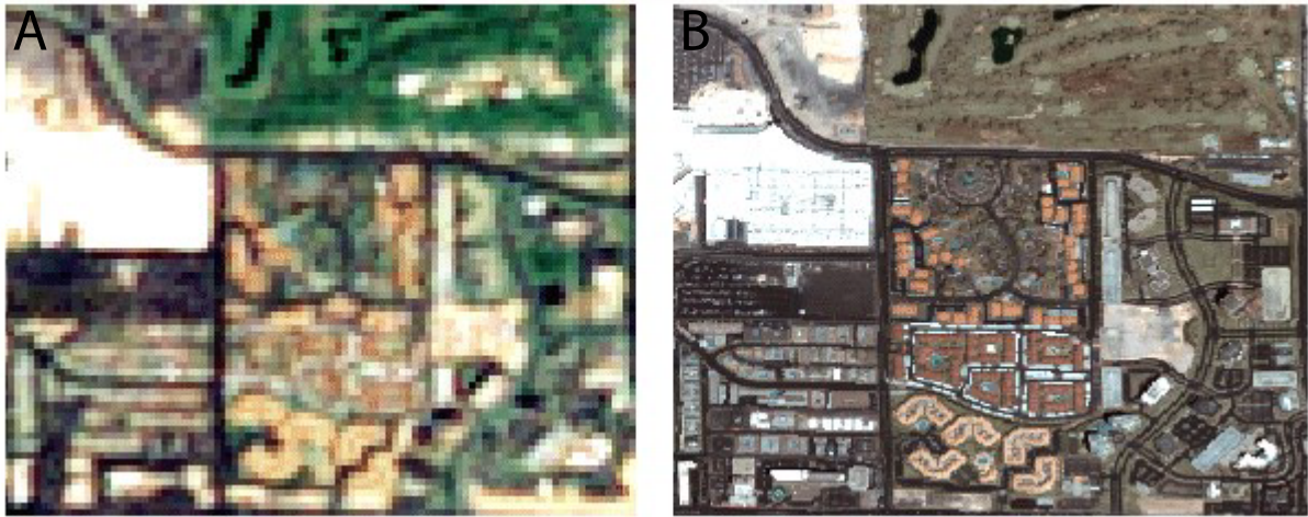
Figura 2.1: Relación entre escala y resolución espacial. A Resolución espacial gruesa y escala de 1:20.000. B Resolución espacial fina y escala de 1:20.000. Imagen extraída de ArcMap, 2016.
