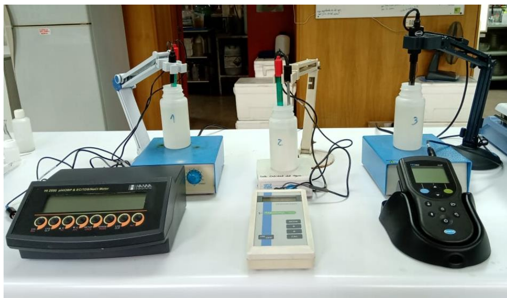
Figura 9: Montaje experimental fase preliminar, de izquierda a derecha se presentan los equipos pHmetro HANNA (1), multiparámetro Eijkelkamp (2) y multiparámetro HACH (3).
