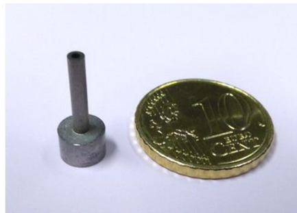
Figura 4.3. Microtobera De Laval convergente-divergente comparada con una moneda de 10 céntimos de euro [21].
