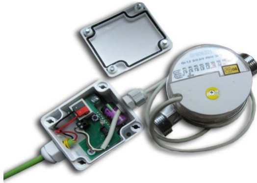
Figura A.5: Caudalímetro digital Arcus - EDS . Fuente: www.arcus-eds.de
