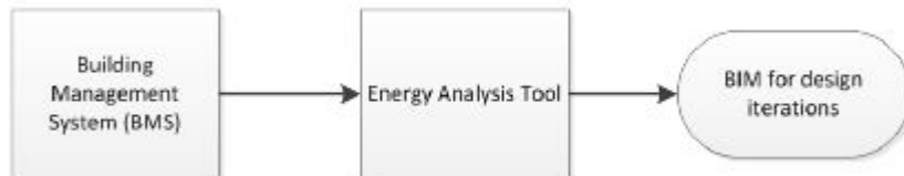
Figura 3.17: Enlace de herramienta de análisis energético Fuente: Akponanabofa 2016
