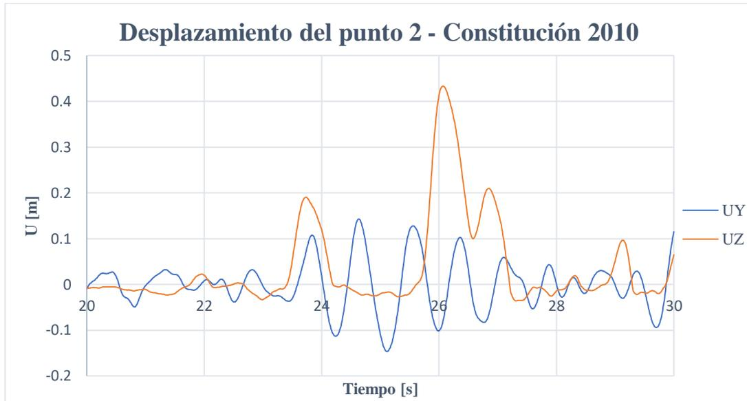
Figura 6.10: Desplazamiento vertical y transversal del punto 2, segundos 20 al 30, registro de Constitución 2010.
