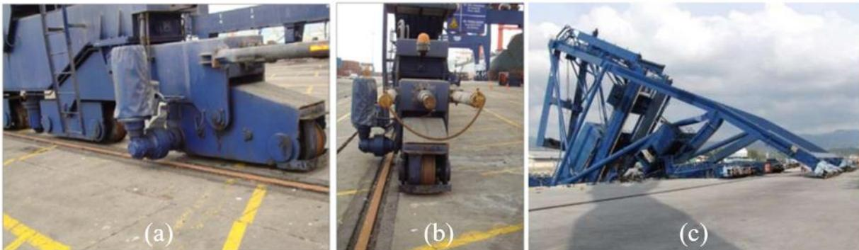
Figura 8.1: (a) y (b) Descarrilamiento en San Antonio, Chile, 2010. (c) Colapso grúa STS en Palu, Indonesia, 2018.
