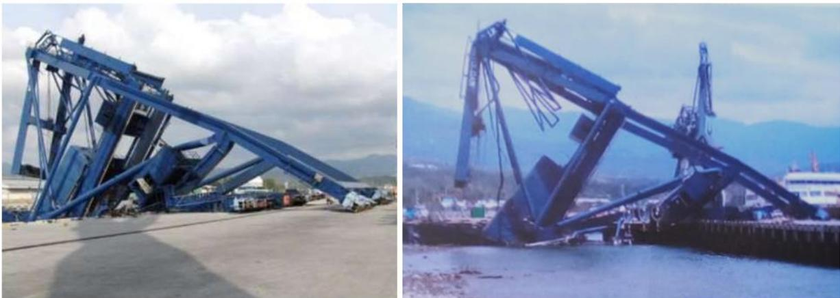
*Figura 3.11: Colapso de grúa STS en Palu, Indonesia, 2018. (Fuente: SIOP Talcahuano 2018).*
