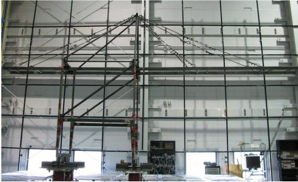
*Figura 3.7: Modelo a escala reducido sobre mesa vibratoria.*
