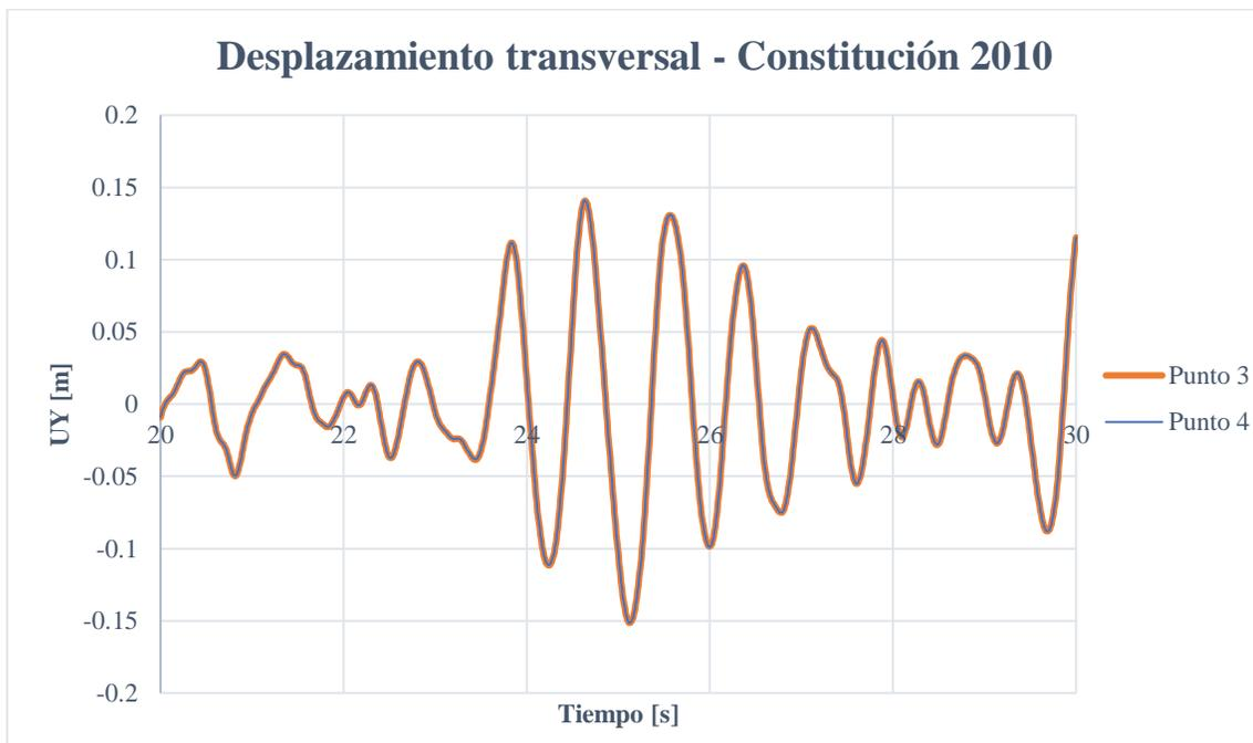
Figura 6.15: Desplazamiento transversal de los puntos 3 y 4, segundos 20 al 30, registro de Constitución 2010.
